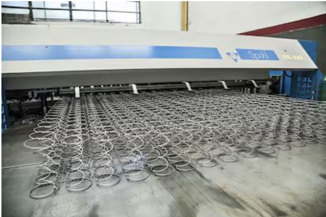
FIG.05: RESORTERA QUE SE ENCARGA DE FABRICAR LOS MUELLES https://www.lanacion.com.ar/lifestyle/sabes-como-se-hacen-los-colchones-nid1985169/
