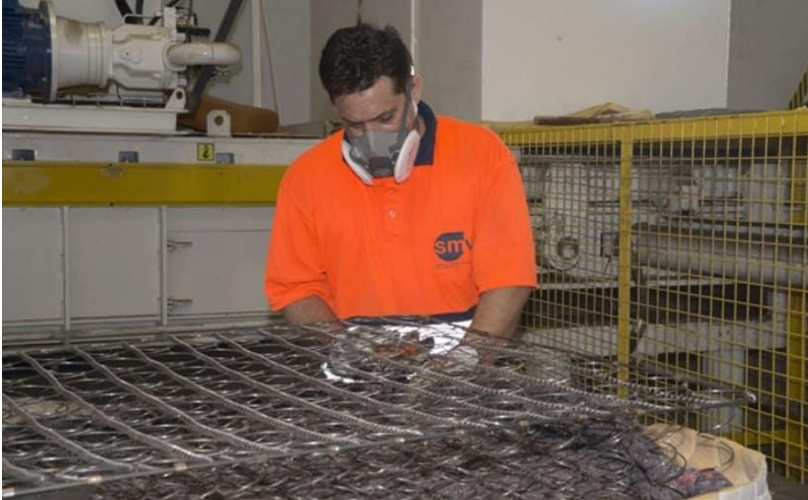
FIG. 53: DESMONTAJE MANUAL DE COLCHÓN DE MUELLES https://www.smv.es/razones-contribuir-reciclaje-colchones/
