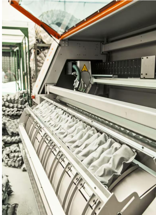
FIG. 10: INTRODUCCIÓN DE LOS MUELLES EN LOS SACOS https://www.lanacion.com.ar/lifestyle/sabes-como-se-hacen-los-colchones-nid1985169/
