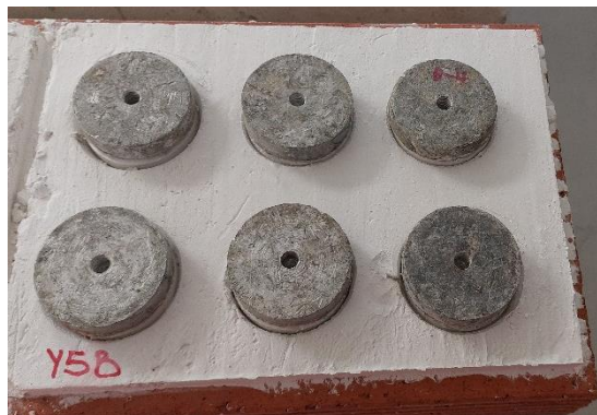
Figura 4.13. Pastillas pegadas para la realización del ensayo
