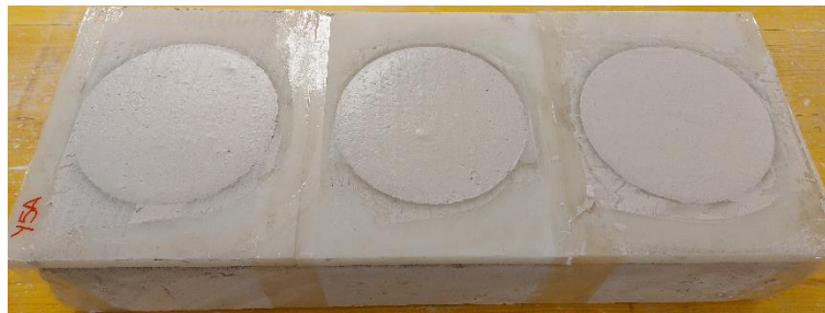
Figura 4.18. Probetas para ensayo de permeabilidad al vapor de agua.
