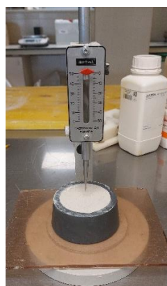
Figura 4.4. Realización ensayo principio de fraguado
