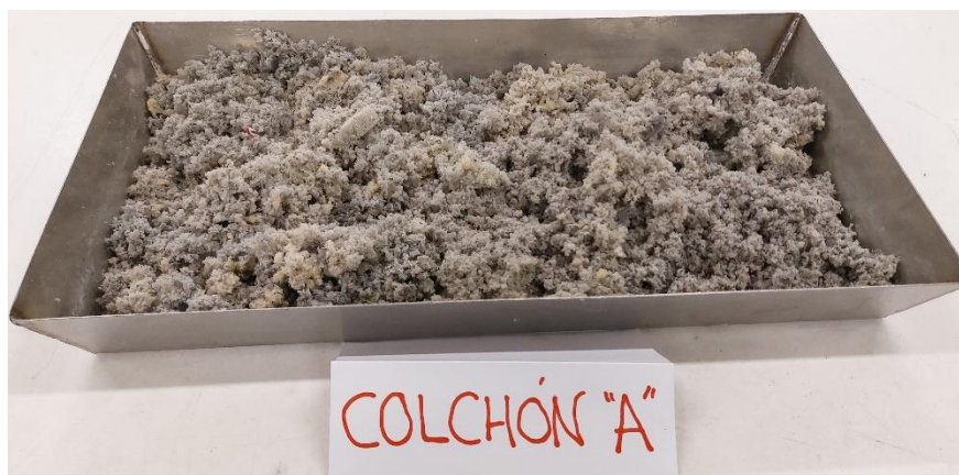
Figura 2.11. Residuo "A" que no consigue picar y tamizar la máquina
