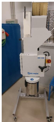
Figura 2.7. Trituradora empleada para procesar el residuo
