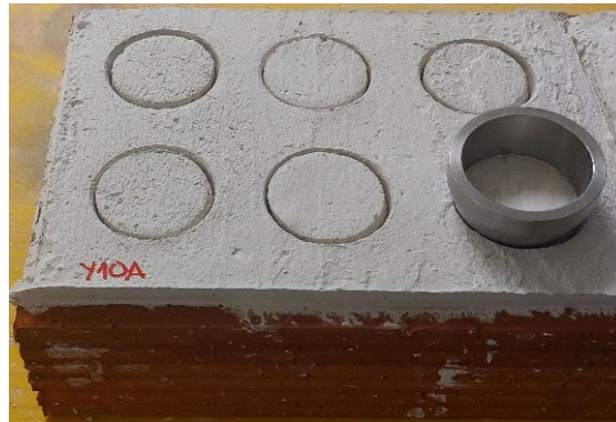
Figura 4.12. Preparación muestras para ensayo de adherencia.
