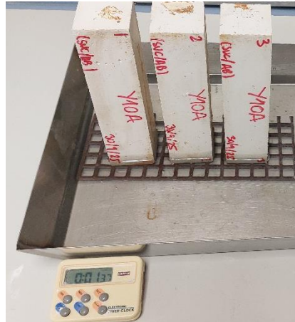
Figura 4.10. Ensayo absorción por capilaridad
