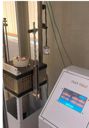
Figura 4.16. Probeta para ensayo no combustibilidad (izquierda) y equipo ensayo no combustibilidad (derecha)
