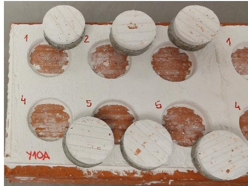
Figura 4.14. Ensayo de adherencia
