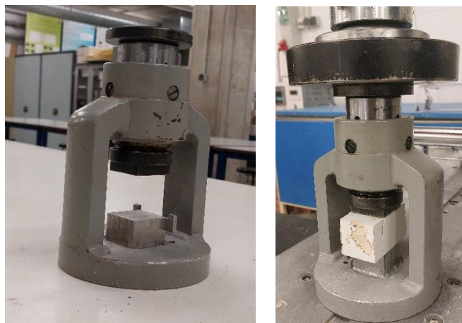
Figura 4.9. Útil para resistencia a compresión (izquierda) y rotura resistencia a compresión (derecha)
