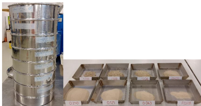
Figura 2.5. Batería de tamices para granulometría (izquierda) y bandejas con el árido separado por tamaño (derecha)
