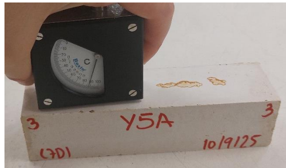
Figura 4.6. Ensayo dureza Shore C
