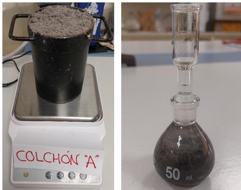
Figura 2.12. Densidad aparente residuo "A" (izquierda) y densidad real residuo "A" (derecha)
