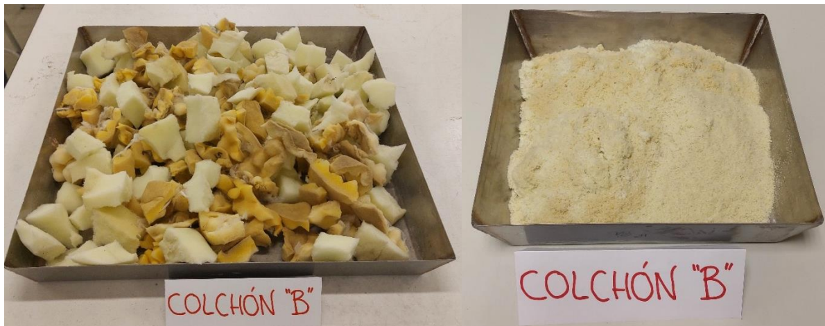
Figura 2.15. Aspecto residuo "B" cortado (izquierda), aspecto residuo "B" triturado (derecha)
