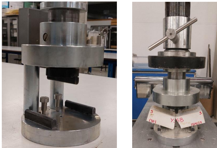
Figura 4.8. Útil para el ensayo de resistencia a flexión (izquierda) y rotura probeta a flexión (derecha)
