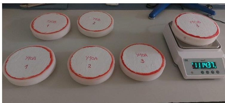
Figura 4.19. Ensayo permeabilidad al vapor de agua.
