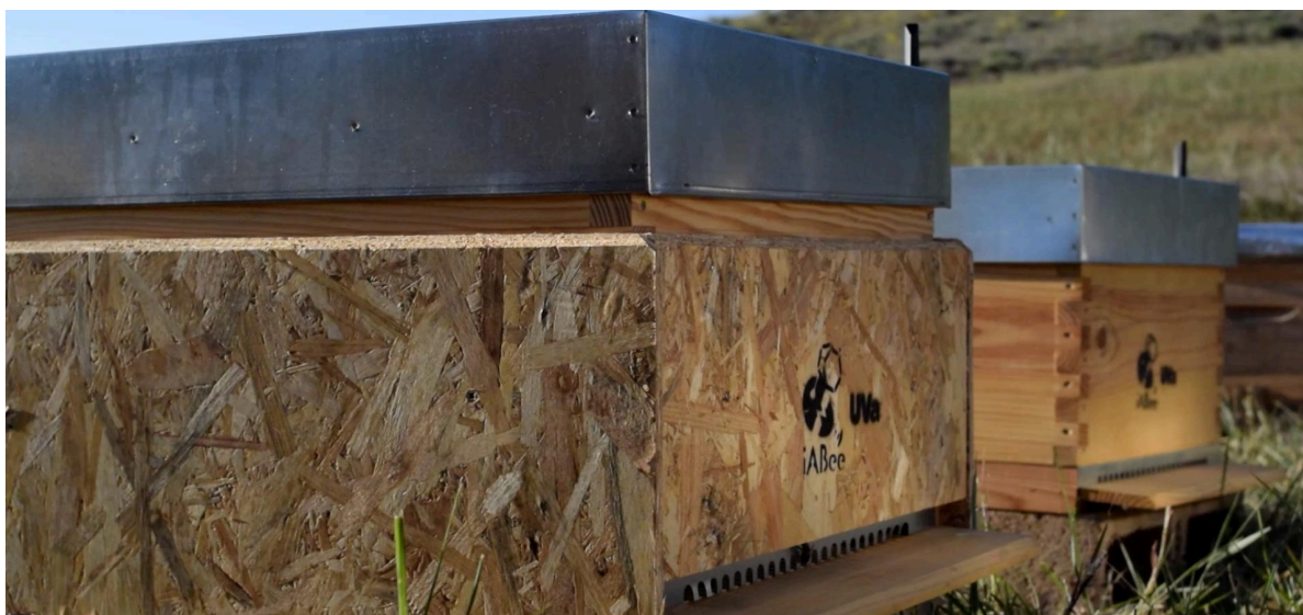
Figura 8: Prototipo aislante diseñado (delante) y colmena control (detrás).
