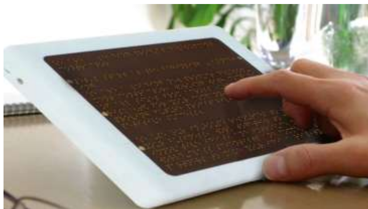
Figura 3. Dispositivo Braille electrónico. Fuente: Adaptado de La Razón, por F. H. Torres D., 2016, https://www.larazon.es/economia/economia-digital/braile-digital-JO11791495/ . Copyright © La Razón. Adaptación propia.
