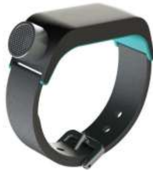
Figura 6. Sunu Band, pulsera-reloj con sistema de detección de obstáculos por medio de ultrasonidos. Fuente: Adaptado de OrientaTech (s.f.), https://orientatech.es/sunu-band/ . Derechos © OrientaTech. Adaptación propia.
