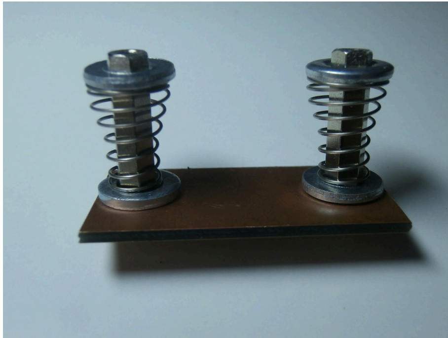
Figura 3.5: Muelles que permiten la basculación
