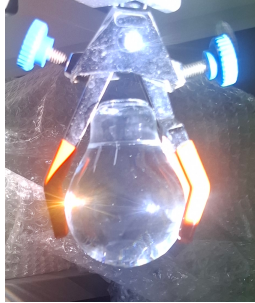
(b) Imagen de la luz reflejada en el interior de una esfera de vidrio conteniendo agua. La imagen ha sido tomada con el polarizador en la posición denominada como vertical.
