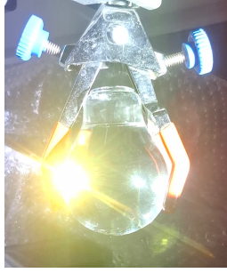
(a) Imagen de la luz reflejada en el interior de una esfera de vidrio conteniendo agua. La imagen ha sido tomada con el polarizador en la posición denominada como horizontal.
