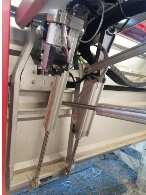
Figura 4.2.3. Sistema de émbolos y cilindros para mover el brazo del robot.
