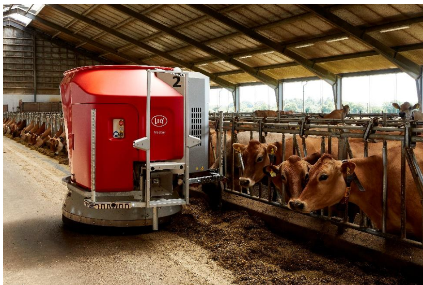
Figura 4.4.2. Lely Vector Next en funcionamiento: acercando y distribuyendo la ración. (Fuente: Lely).
