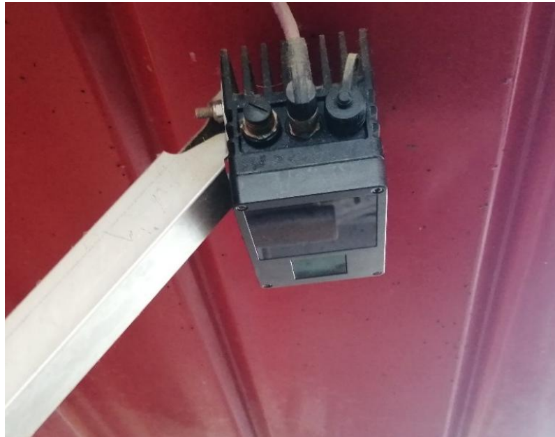
Figura 4.2.1. Cámara 3D para escanear al animal y detectar su posición dentro del robot.
