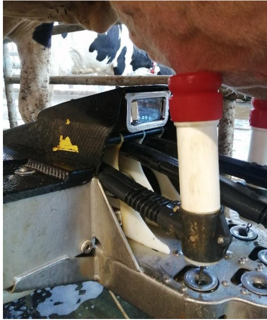
Figura 4.2.5. Cámara de láser 3D instalada en el brazo para escanear la ubre de la vaca.
