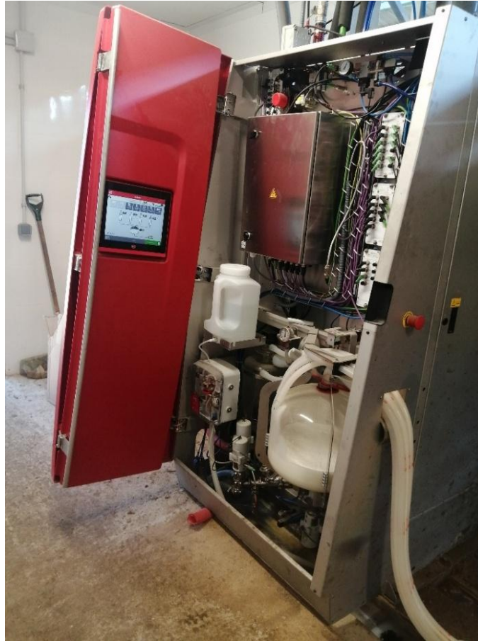
Figura 4.2.15. Vista general del armario del robot. Podemos ver la forma en la que se abate la puerta.
