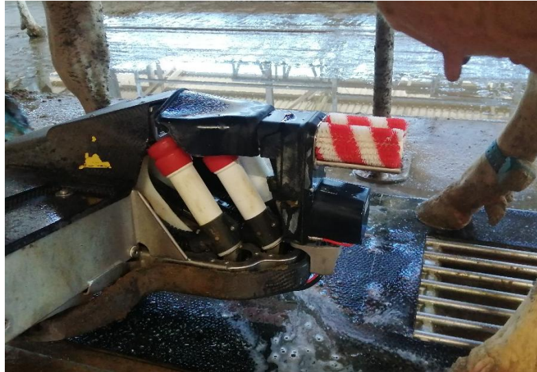
Figura 4.2.4. Rodillos en posición de limpieza con la bandeja de plástico cubriendo las pezoneras.
