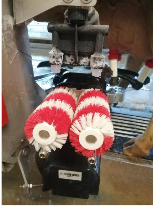
Figuras 4.2.6. y 4.2.7. Sistema de limpieza con agua de los rodillos y la bandeja de plástico.
