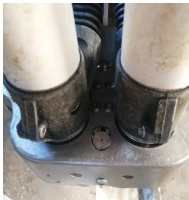
Figuras 4.2.8. y 4.2.9. Posición del lanzador de yodo entre las pezoneras traseras. Detalle del orificio lanzador.
