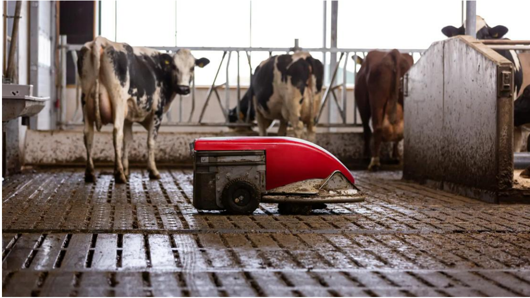
Figura 4.5.3. Lely Discover Scraper limpiando el suelo de un patio. (Fuente: Lely.com)
