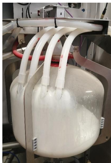
Figura 4.2.11. Jarra de la leche, donde llegan los tubos que conducen la leche desde las cuatro pezoneras.
