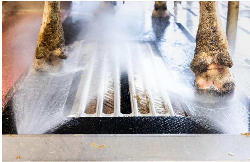
Figura 4.3.1: Lely Meteor aplicando el producto sanitario sobre las patas de la vaca. (Fuente: Lely Center).
