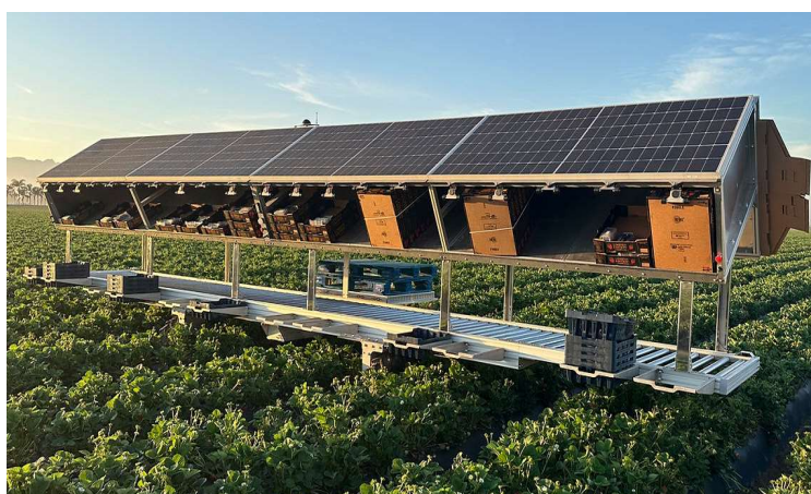
Figura 22: Agrobot ha desarrollado las Cosechadoras Serie E (Las primeras cosechadoras robóticas precomerciales para cosechar fresas delicadamente) (Imagen tomada de Agrobot, s.f.)
