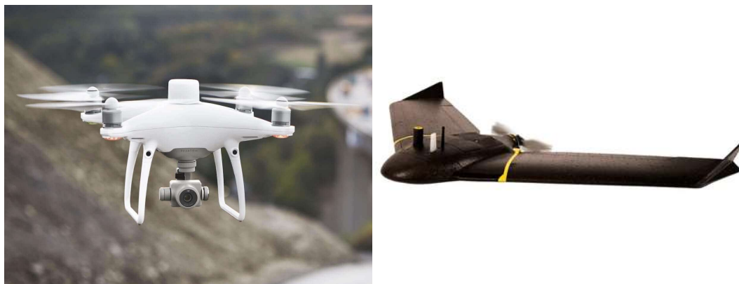
Figura 16: Comparativa de drones agrícolas: el DJI Phantom 4 RTK (izquierda), un dron multicóptero especialmente diseñado para tareas de topografía y cartografía de alta precisión, y el SenseFly eBee X (derecha), un dron de ala fija para el mapeo y la recopilación de datos.
