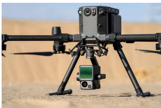
Figura 17: Imagen del DJI Zenmuse L1, un sensor LiDAR + RGB diseñado para drones como el Matrice 300 RTK, ideal para tareas de topografía aérea y modelado 3D (Imagen tomada de Commercial UAV News, s.f.)
