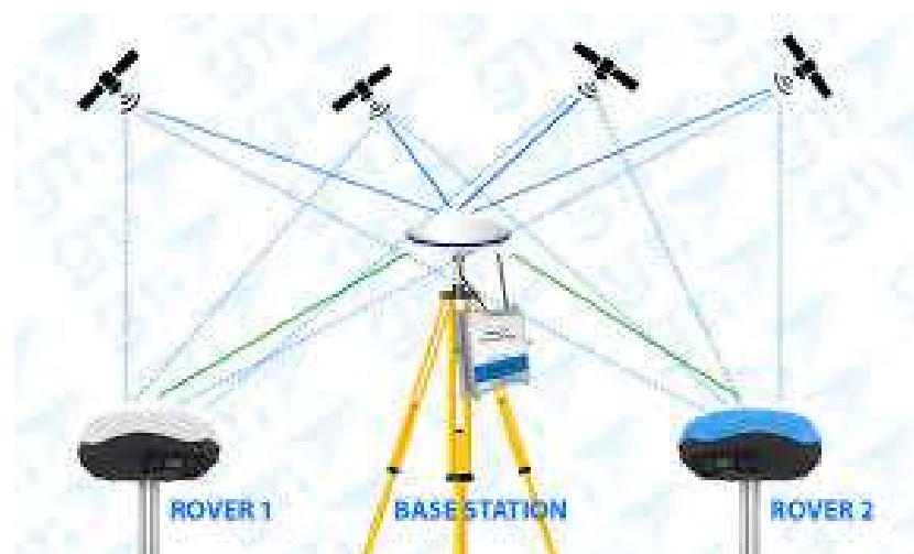
Figura 10: Esta imagen muestra un sistema GNSS RTK típico, incluyendo el receptor móvil y la estación base, elementos clave para lograr posicionamiento centimétrico en tiempo real (Imagen tomada de GeoMeter, s.f.)
