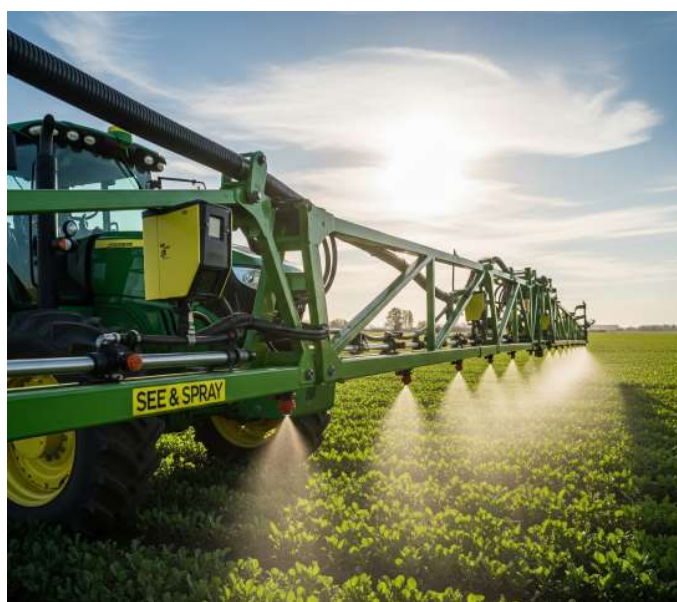
Figura 15: Sistema See & Spray de John Deere en un campo de cultivo (Imagen tomada de John Deere, s.f.)
