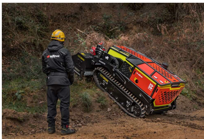
Figura 23: Imagen del Agrobot Dronster, un robot multifuncional de origen español diseñado para operar en terrenos difíciles, especialmente en contextos forestales, agrícolas y de emergencia (Imagen tomada de Vallfirest, s.f.)
