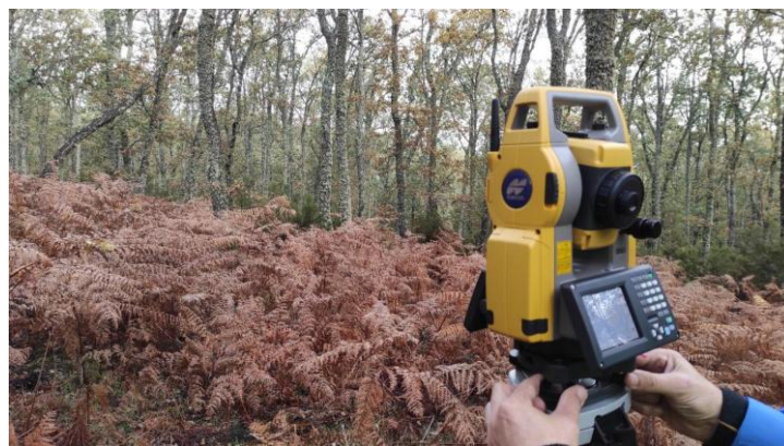
Figura 7. Operario calibrando la estación total
