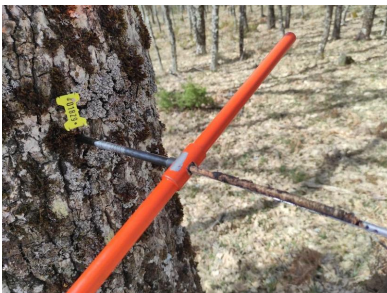
Figura 9. Extracción de muestras de madera con barrena Pressler
