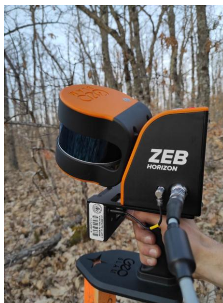
Figura 8. Dispositivo LiDAR HLS utilizado para escanear mientras se posiciona en una de las estacas de las parcelas
