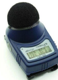
ILUSTRACIÓN 1. DOSÍMETRO. FUENTE: MANUAL DE USUARIO DEL CEL-350 DBADGE DE CASELLA.
