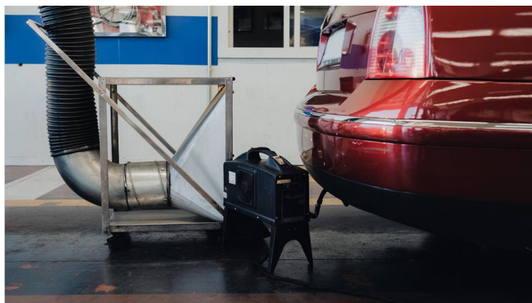
Figura 7. Ejemplo de prueba de emisiones de gases realizada en una ITV. Fuente: AECA-ITV 45
