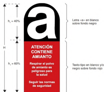
Ilustración 7. Etiqueta reglamentaria de identificación de materiales con amianto según el Anexo II del R.D. 1406/1986. Fuente: INSST.
