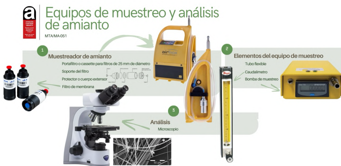
Ilustración 17. Equipos de muestreo y análisis de amianto. Fuente: elaboración propia.
