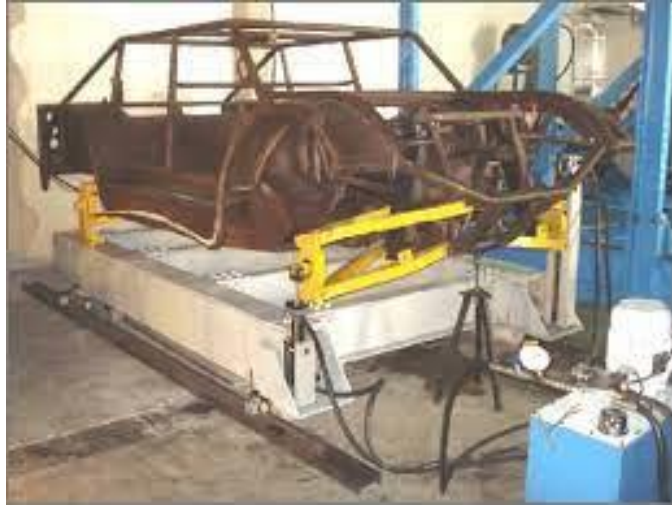
Figura 62. Fotografía de un ensayo de torsión sobre el chasis de un vehículo todoterreno [17].
