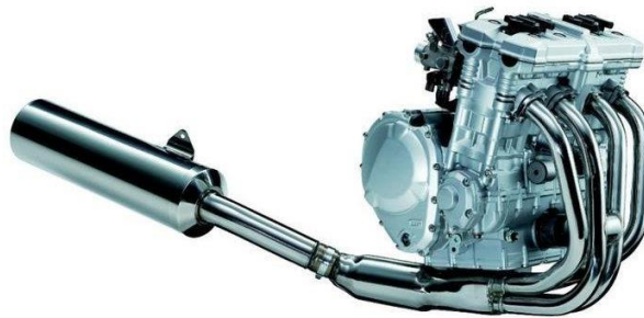
Figura 3. Motor Suzuki Bandit 650 refrigerado por agua [9].
