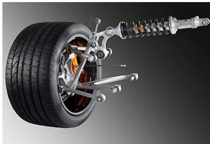
Figura 11. Ejemplo de una suspensión tipo push rod. [10]
