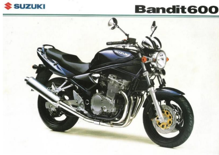
Figura 2. Motor Suzuki Bandit refrigerado por aire (con aletas disipadoras) [8].
