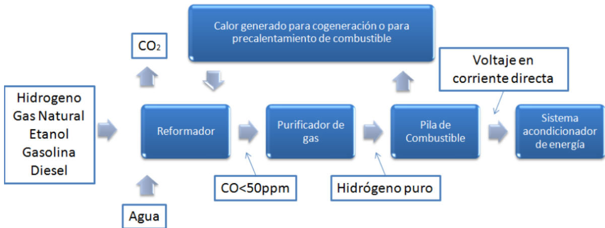
Ilustración 27. Sistema genérico de una pila de combustible.
