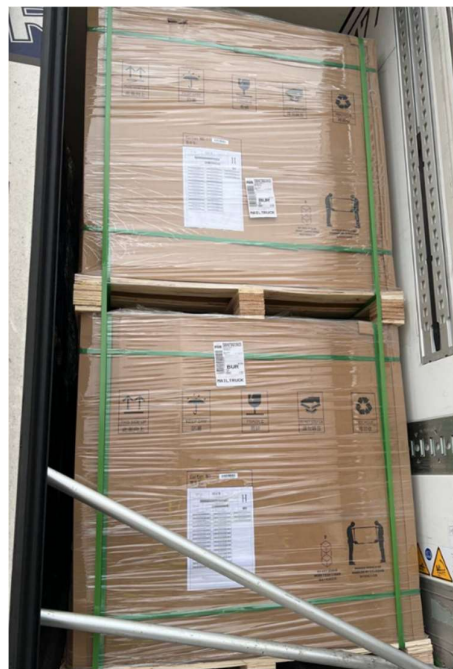
Ilustración 42 Modo de embalaje y transporte de los paneles solares de JA SOLAR (Operario, 2023)
