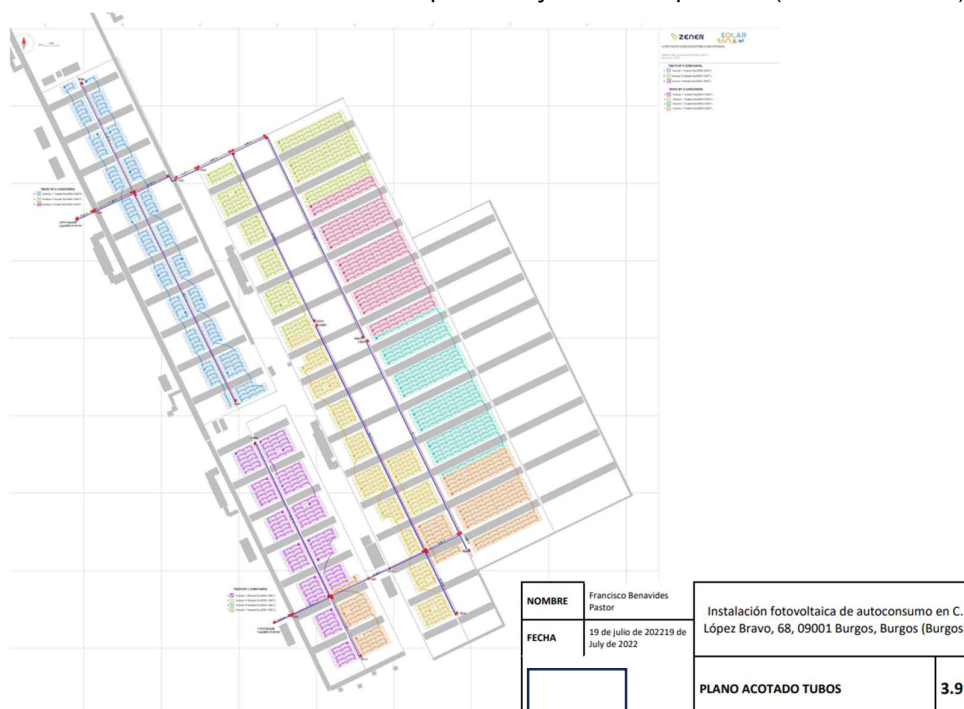
Ilustración 37 Plano del recorrido de los tubos de protección de cableado CC, desde los paneles hasta los inversores (Francisco Benavides Pastor, 2022)
