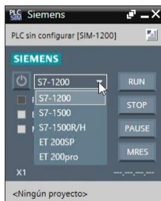
Figura 17. Simulación de un PLC con PLCSIM
