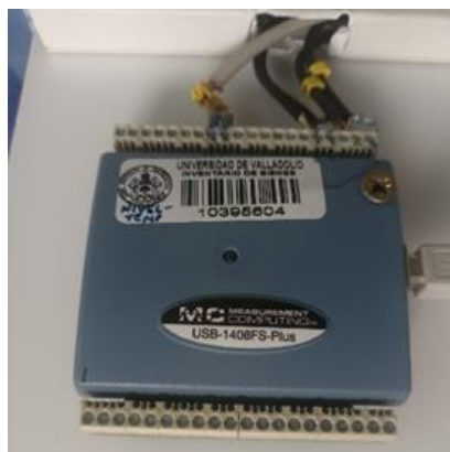
Figura 8. Tarjeta DAQ USB-1408FS-Plus de MC
