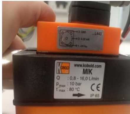
Figura 6. Caudalímetro de KOBLOD tipo MIK
