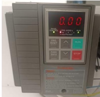
Figura 7. Variador de frecuencia FVRO.4E9S-7EN de Fuji
