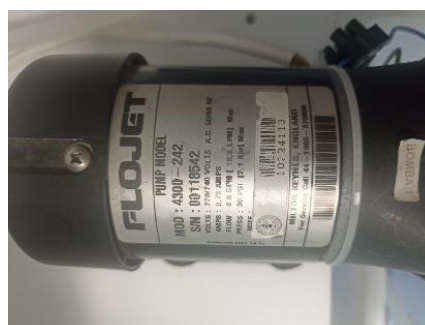
Figura 3. Bomba modelo 4300-242 de FloJet
