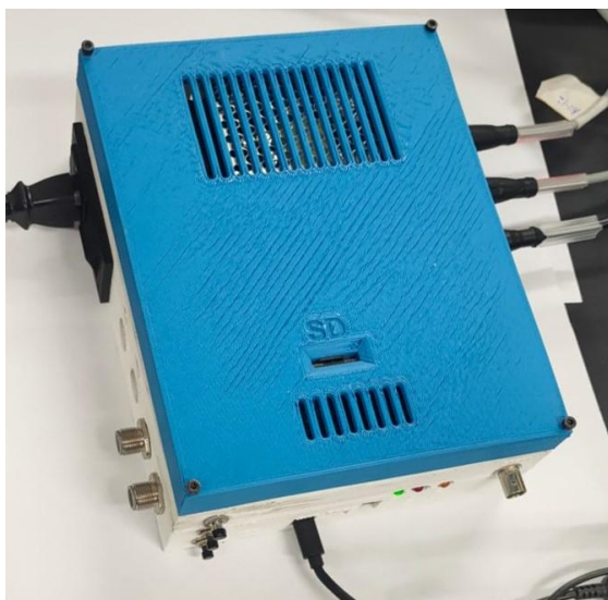
FIGURA 22. CAJA DE CONTROL. A LA DERECHA SE PUEDEN VER LAS TRES ENTRADAS, A LA IZQUIERDA LA ALIMENTACIÓN Y EN LA PARTE INFERIOR DE LA IMAGEN LA CONEXIÓN AL ORDENADOR.
