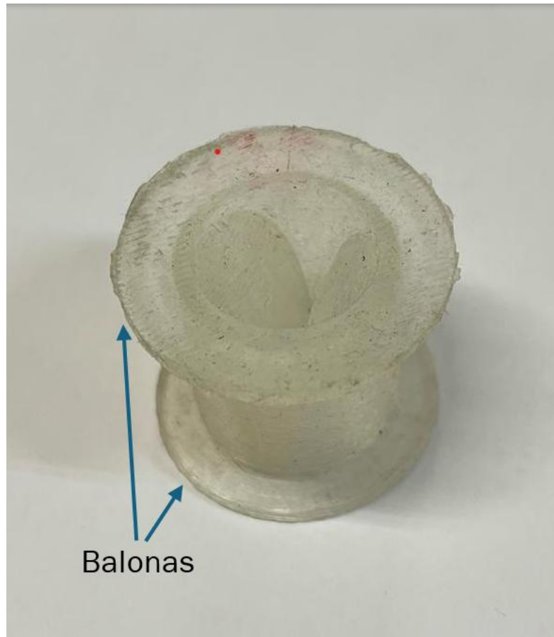
FIGURA 24. VÁLVULA REAL. SEÑALADAS CON FLECHAS LAS BALONAS, NECESARIAS PARA PODER SUJETAR LA VÁLVULA EN EL PORTA VÁLVULAS.
