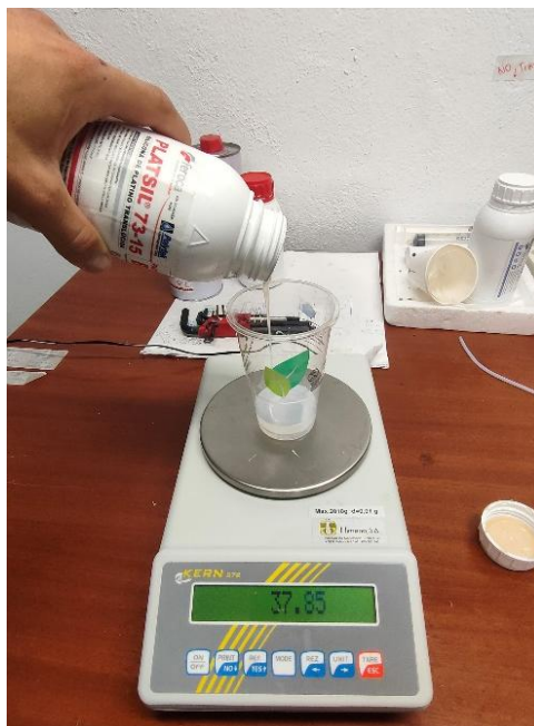
FIGURA 43. VERTIDO DE COMPUESTO EN EL VASO DE MEZCLAS.
