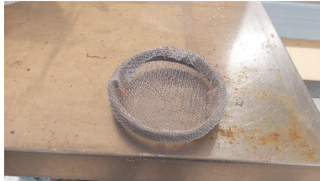
Figura 4-4 Malla metálica cubriendo al anillo
