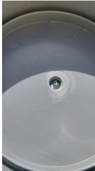
Figura 5-1 Tapa de PVC taladrada con un pequeño chaflán
