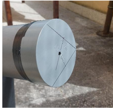
Figura 4-10 Tapa de PVC taladrada
