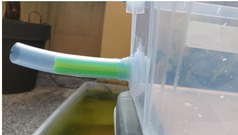
Figura 3-20 Tubo con elementos direccionadores más cortos en su interior
