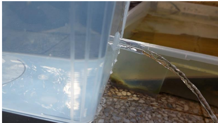
Figura 3-12 Vaciado de un depósito a través de un tubo con d=8\text{ mm} y L=50\text{ mm}
