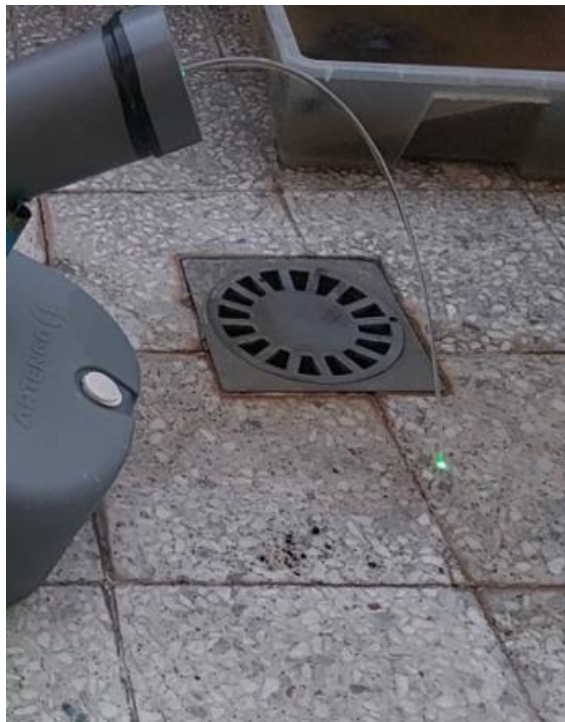
Figura 5-11 Luz del LED reflejada a lo largo del chorro laminar
