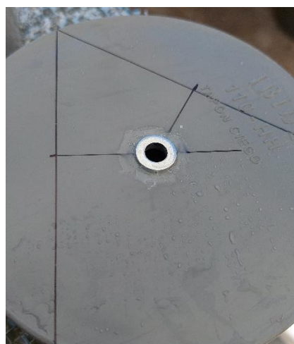
Figura 4-13 Tapa de PVC con arandela metálica pegada
