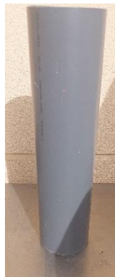
Figura 4-2 Tubo de PVC con L=450 mm
