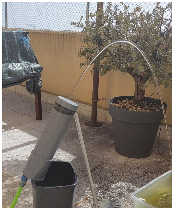
Figura 5-3 Chorro laminar arqueado
