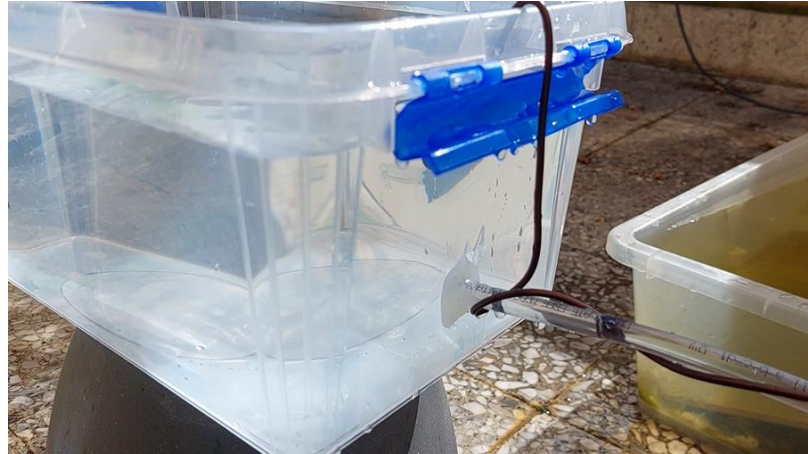
Figura 3-17 Depósito con un tubo con D=5\text{ mm} y L=500\text{ mm}
