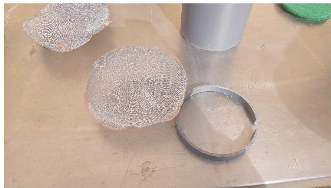
Figura 4-3 Anillo de PVC y malla metálica
