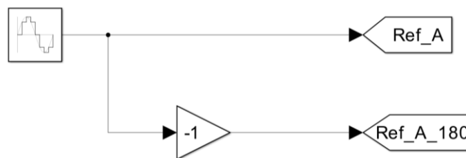
Figura 35. Generación de la onda senoidal. Elaboración propia en Matlab Simulink [23].
