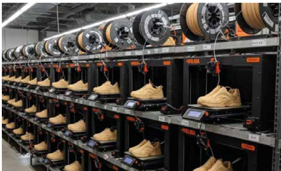
Figura 66. Impresoras 3D de Prusa imprimiendo calzado de Koobz
