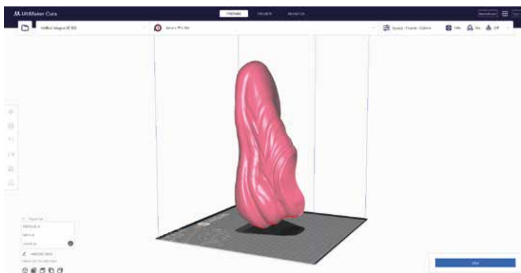
Figura 154. Modelo de la zapatilla introducido en Cura Ultimaker
