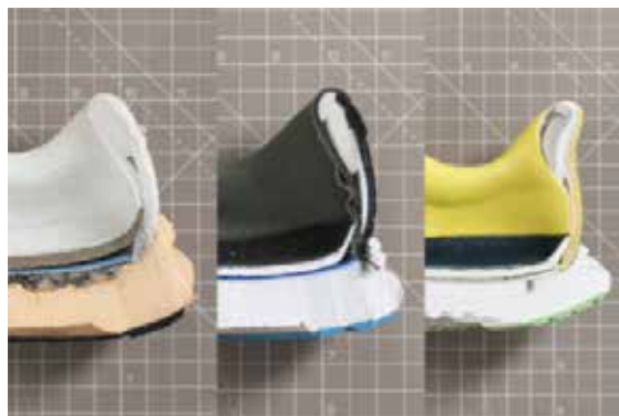
Figura 78. Sección de una zapatilla en la que se aprecia el contrafuerte
