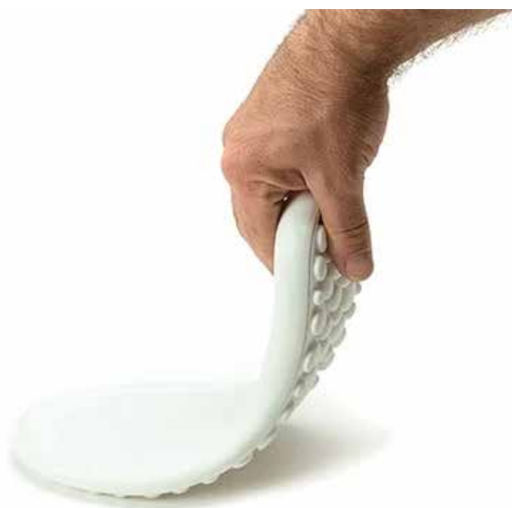
Figura 72. Prueba de flexibilidad de una suela fabricada con TPU
