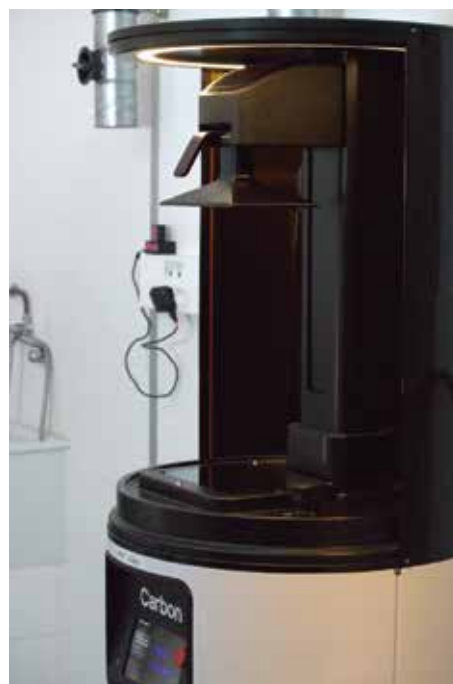
Figura 75. Impresora DLS de Carbon 3D
