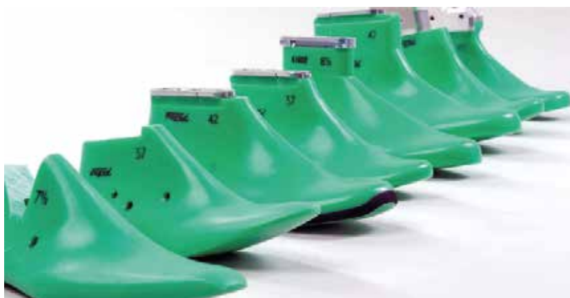
Figura 76. Hormas estandarizadas para diseñar dsitinto tipo de calzado
