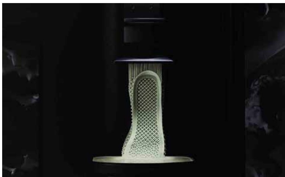
Figura 57. Mediasuela fabricada con tecnología DLS
