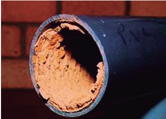
Fig. 237 Depósitos en el interior de una tubería de PVC
