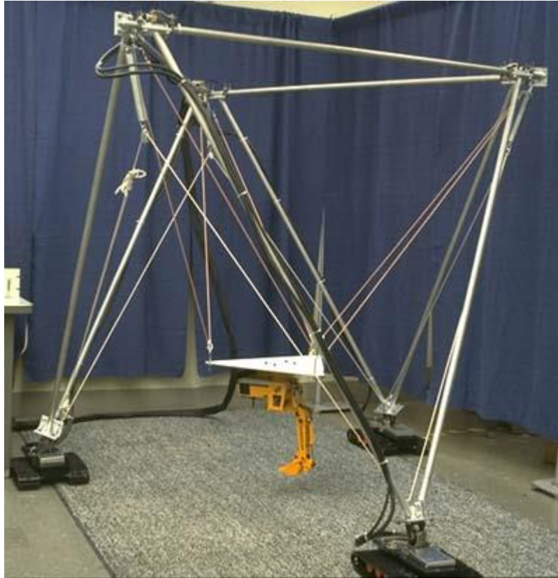
Figura 3. ROBOCRANE – Robot paralelo desarrollado por NIST
