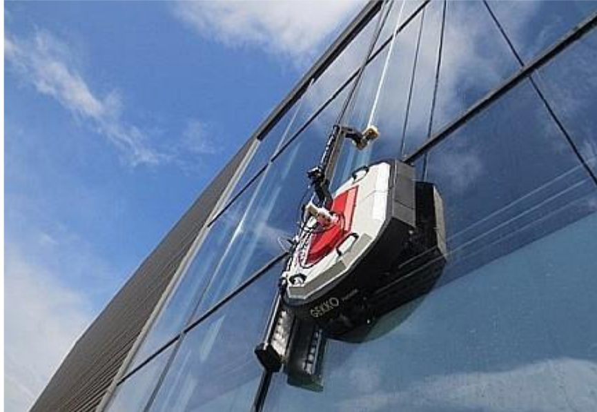
Figura 4. Robot de cables para limpieza de fachadas [4]
