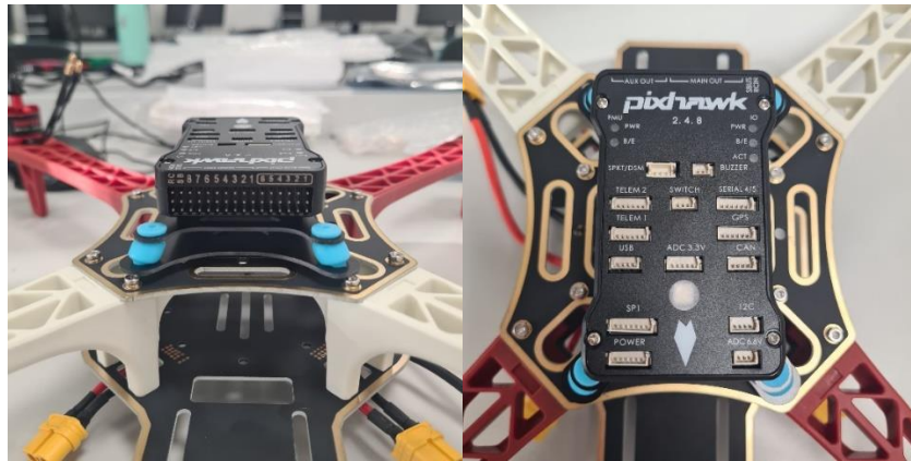
Ilustración 42: Montaje Controlador integrado en chasis
