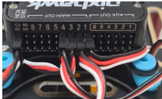
Ilustración 46: Montaje, conexiones Motor-ESC-Pixhawk
