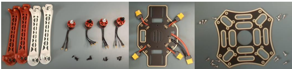
Ilustración 35: Montaje, piezas chasis y motores
