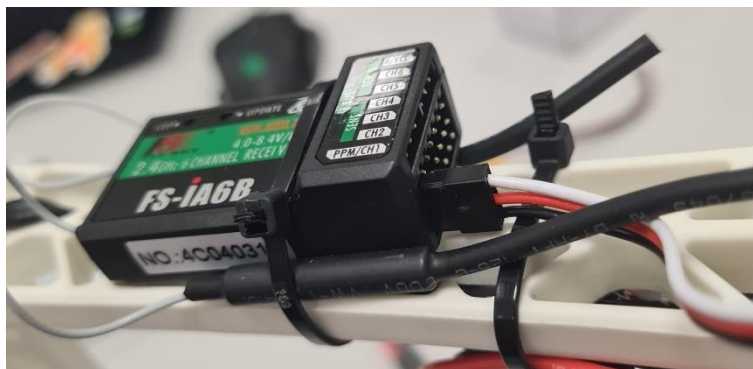
Ilustración 56: Montaje, receptor de control manual
