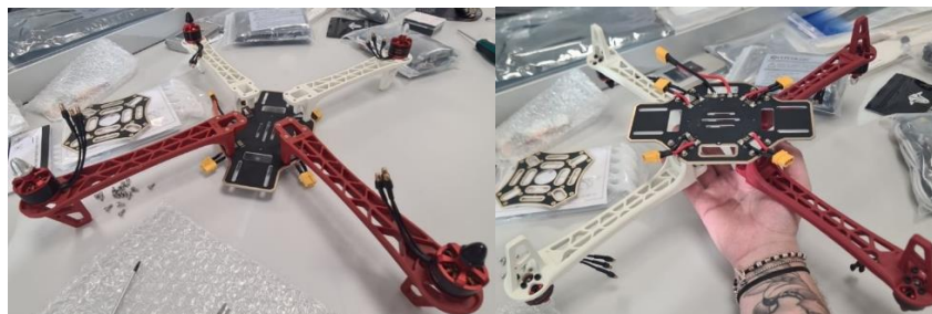
Ilustración 37: Montaje, placa inferior (colocar al revés)
