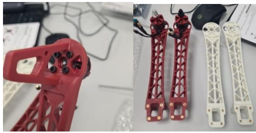
Ilustración 36: Montaje, motor atornillado y forma de alternarlos
