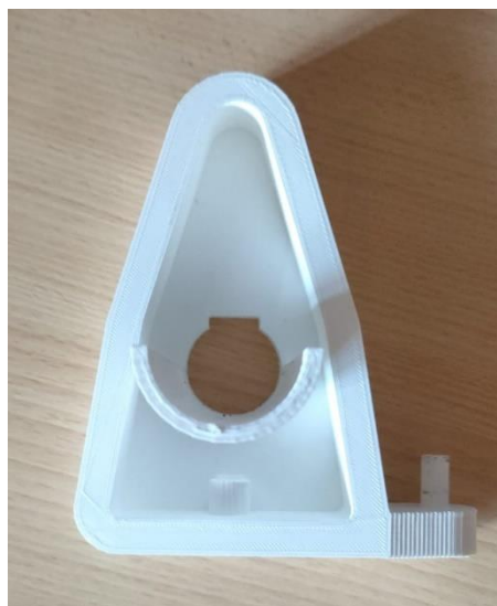
Figura 74: Sujeción motor rotativo impresa en 3D, extraído de [elaboración propia]
