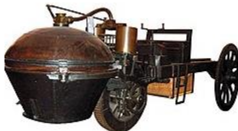
Figura 11: Vehículo autopropulsado por Nicolas-Joseph Cugnot
