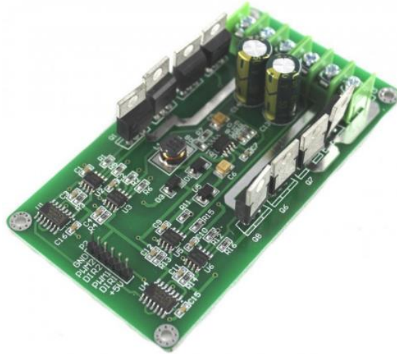
Figura 38: Imagen de puente H
