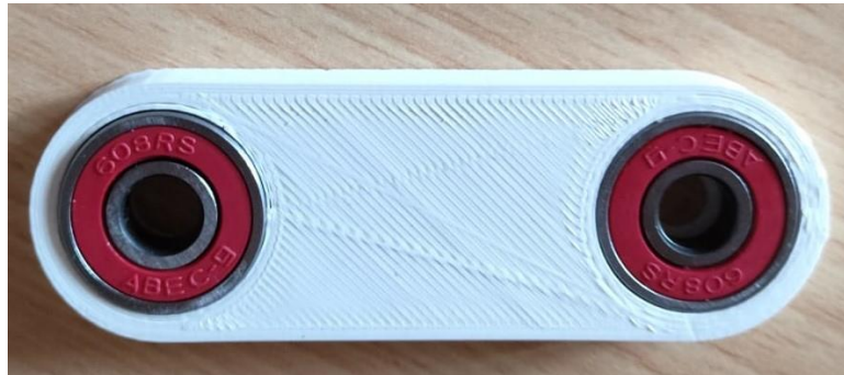
Figura 76: Tirante de dirección impreso en 3D
