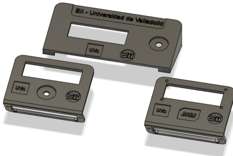
Figura 69: Versiones anteriores del HMI con el codificador integrado, junto a la versión actual.
