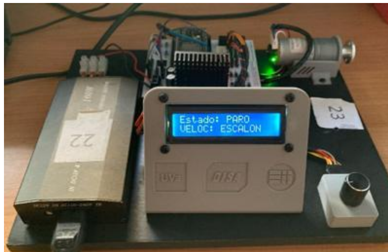
Figura 52: Maqueta en funcionamiento. Modo de identificación sin conexión. Elaboración propia.
