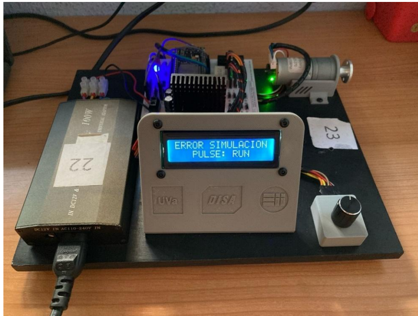
Figura 53: Modo de control Simulink. Conexión directa con MATLAB/Simulink. Elaboración propia.
