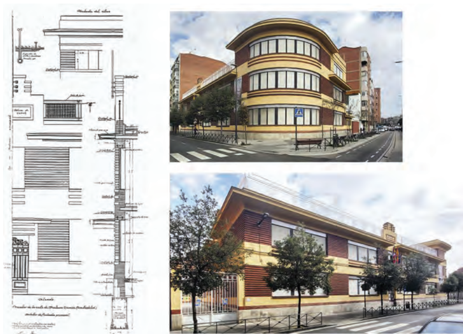
Fig.15. Plano de detalles constructivos del proyecto original de Joaquín Muro de 1932 (izquierda) y fotografías recientes del actual colegio San Fernando de Valladolid (derecha) (Fuente: Rodríguez Méndez, 2008; autor)
