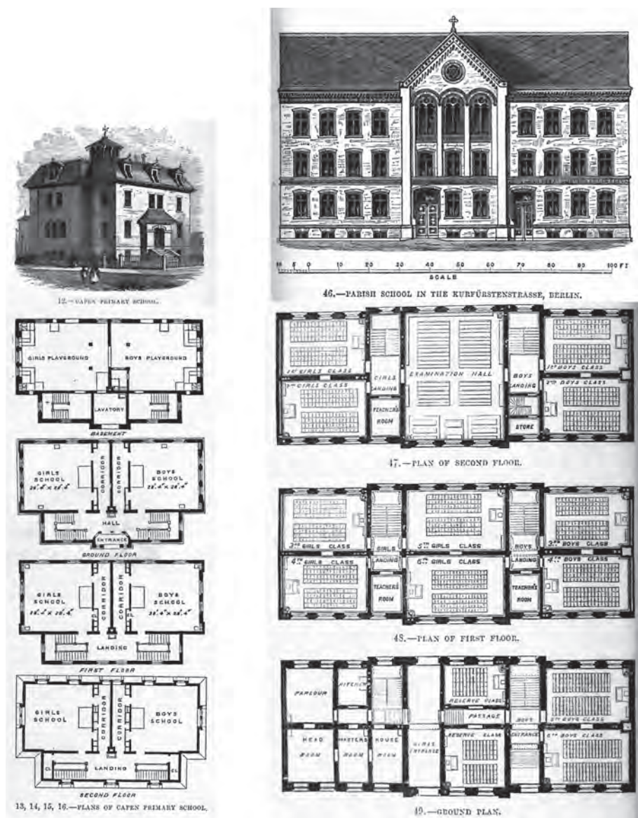
Fig. 2. Edificios escolares con separación de aulas por criterios de género mediante “yuxtaposición” en Capen, y trabada “a media madera” en Berlín, en el libro School Architecture (Fuente: Robson, 1874: 30-31 y 77-78).
