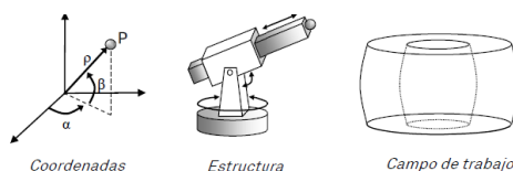
Figura 30. Estructura y campo de trabajo del robot esférico (Fraile Marinero, 2023)
