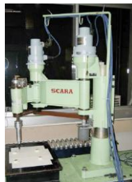
Figura 16. SCARA (A. Gasparetto, s.f.)
