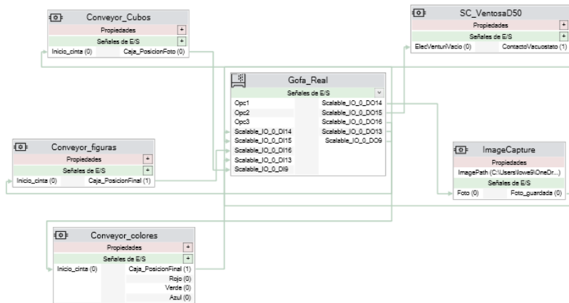
Figura 189. Conexión del componente inteligente “Conveyor_Cubos” al controlador virtual
