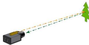
Figura 45. Sensor de tiempo de vuelo (ToF) (Yoigo, 2025)
