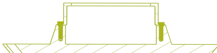
Ilustración 67: Ensamblaje de la abrazadera a la tapa [Elaboración propia]
