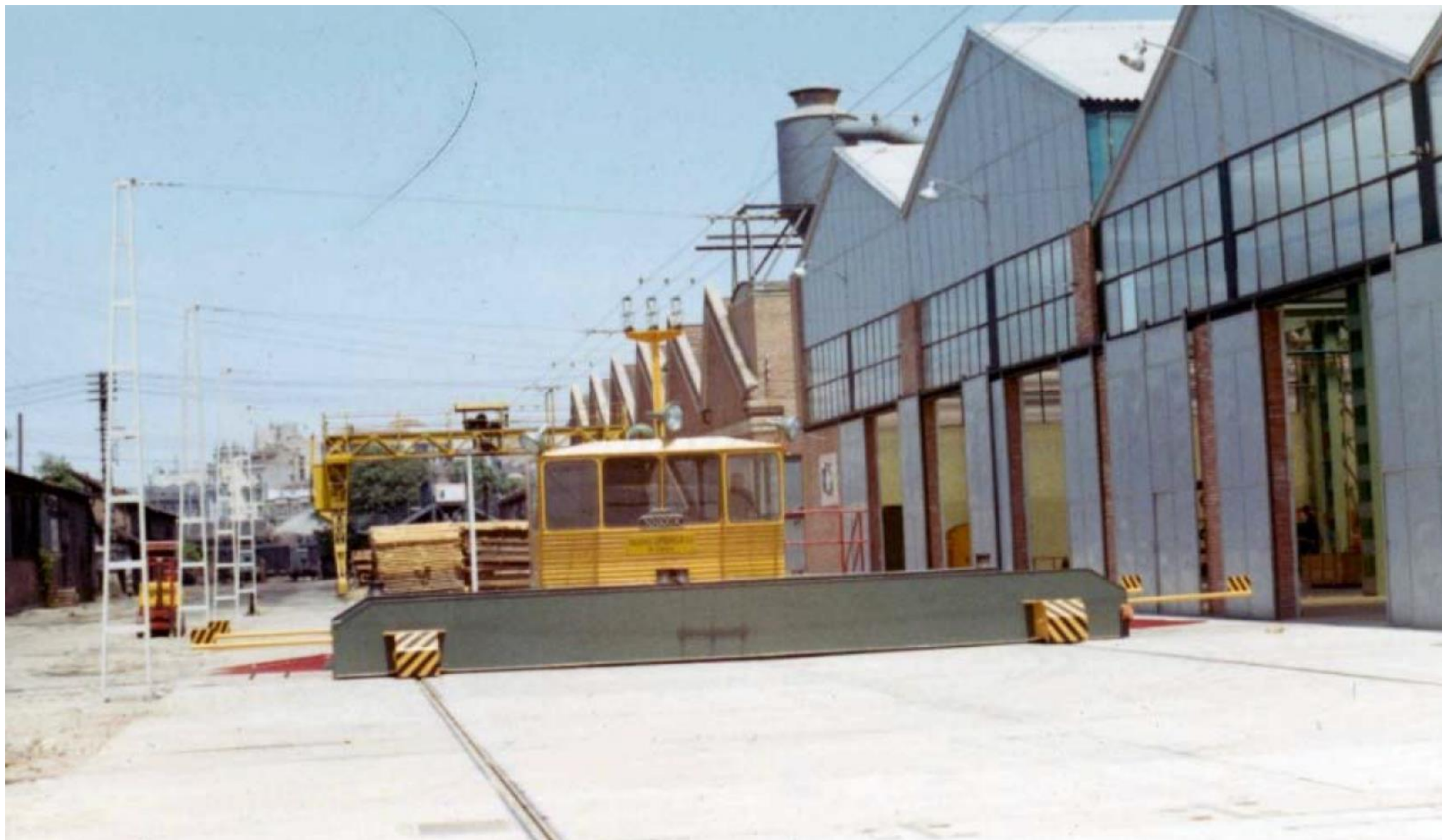
Figura 68 Carro transbordador sin foso para vagones, Talleres generales de Valladolid. (Santos, 1960)
