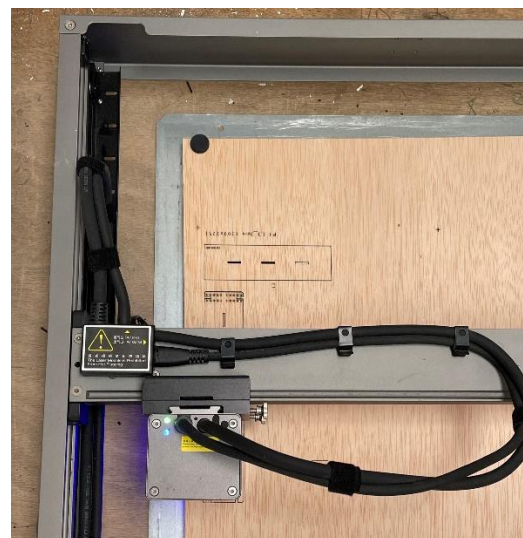
Figura 2.7. Crea-LightBurn 2 grabando y cortando una lámina de madera.
