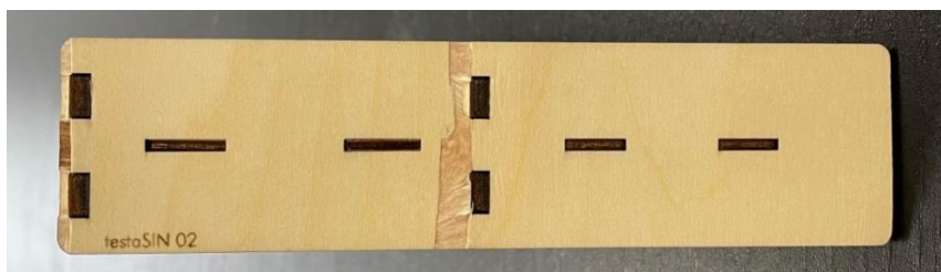
Figura 2.11. Ejemplo de la reacción de la madera frente a un encaje secundario con reducciones aplicadas.
