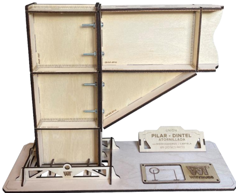
Figura 2.29. Maqueta de unión pilar-dintel atornillada con rigidizadores y cartela (vista frontal).
