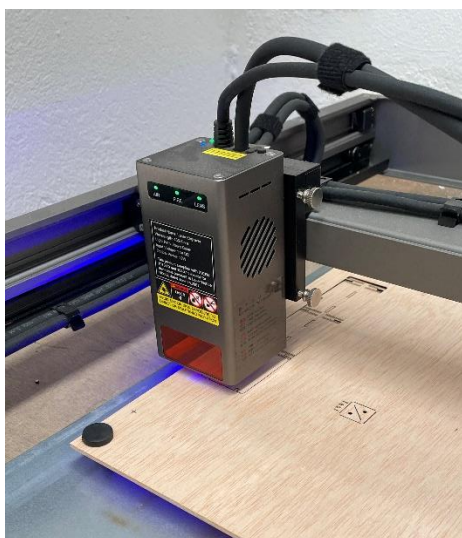
Figura 2.7. Crea-LightBurn 2 grabando y cortando una lámina de madera.
