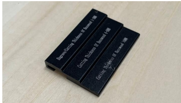
Figura 2.6 Útil para regular la distancia del cabezal del láser a la madera.
