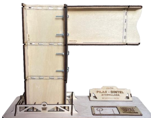
Figura 2.21. Maqueta de unión pilar-dintel atornillada sin rigidizadores ni cartela (vista frontal).
