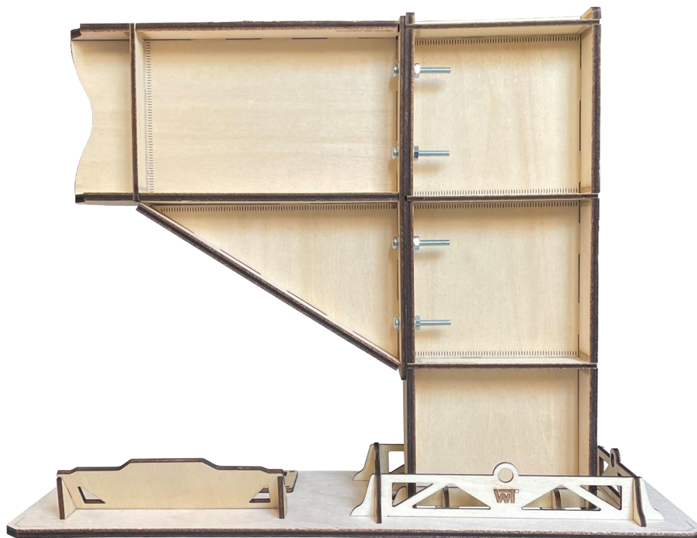
Figura 2.32. Maqueta de unión pilar-dintel atornillada con rigidizadores y cartela (vista posterior).
