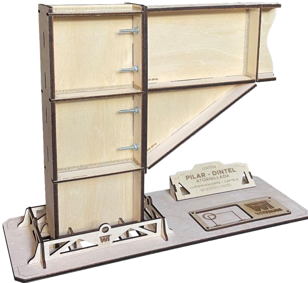
Figura 2.30. Maqueta de unión pilar-dintel atornillada con rigidizadores y cartela (perspectiva).
