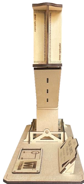
Figura 2.31. Maqueta de unión pilar-dintel atornillada con rigidizadores y cartela (perfil).
