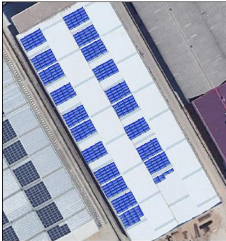
Figura 7. Situación de los módulos fotovoltaicos sobre la cubierta de la nave.
