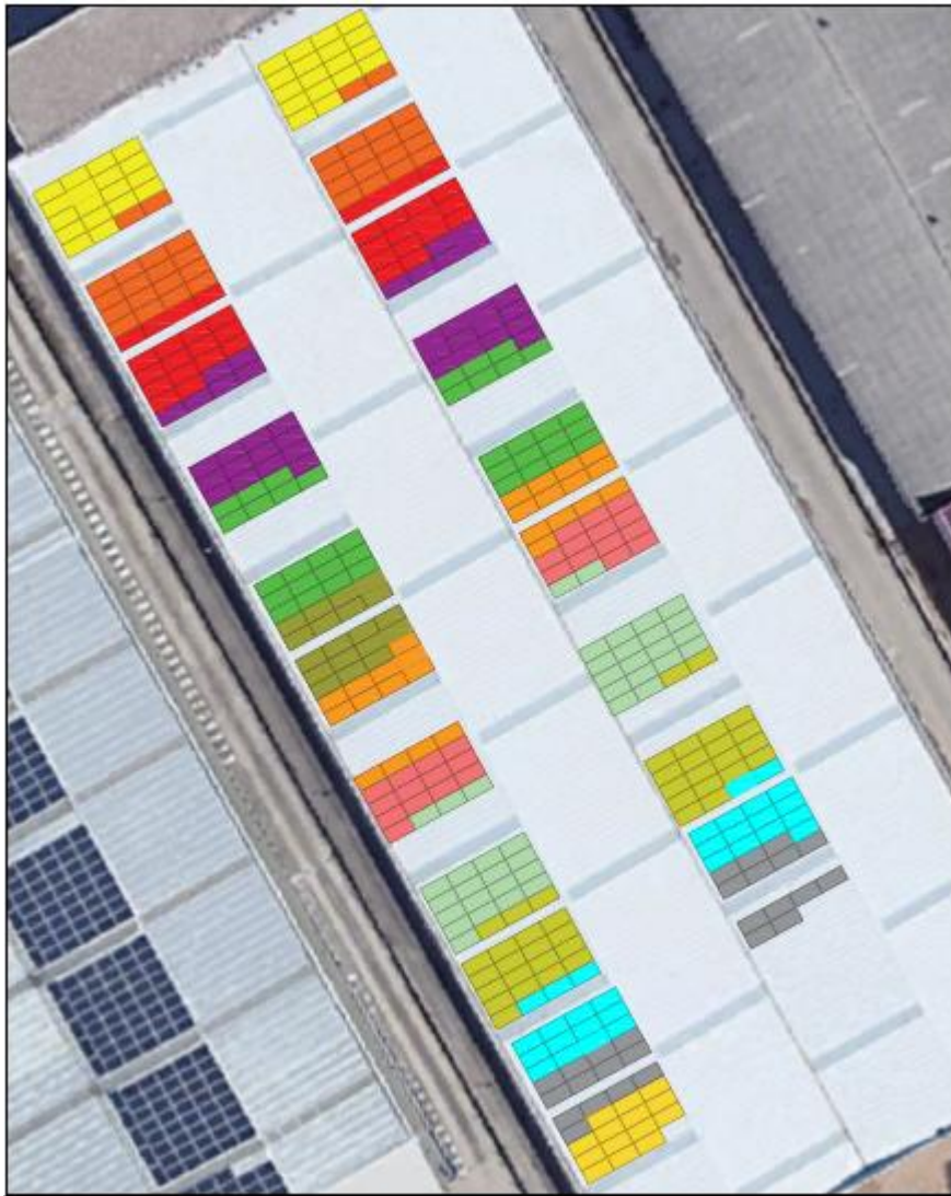
Figura 8. Disposición de los String sobre la cubierta de la nave objeto de estudio.
