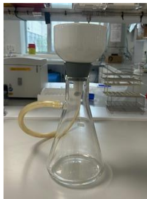
Figura 10. Embudo Büchner y matraz Kitasato para la filtración
