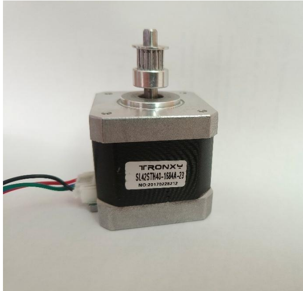
Figura 20: Motor SL42STH40-1684A-23. Fuente: Elaboración Propia
