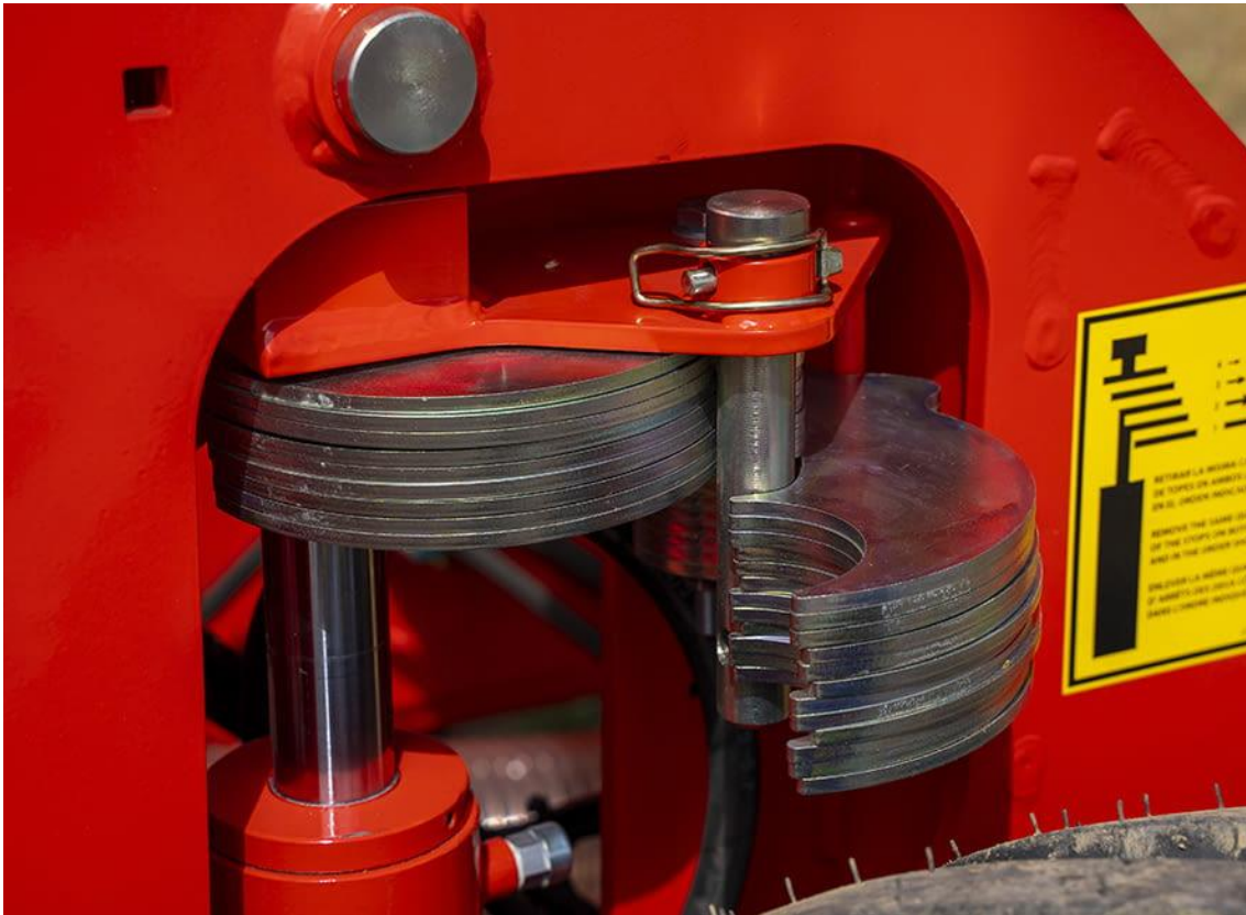
Ilustración 7: Topes profundidad sembradora fuente {1}
