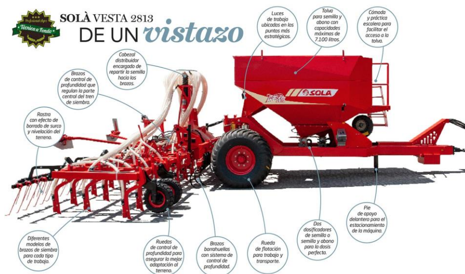
Ilustración 1: Partes sembradora fuente [1]
