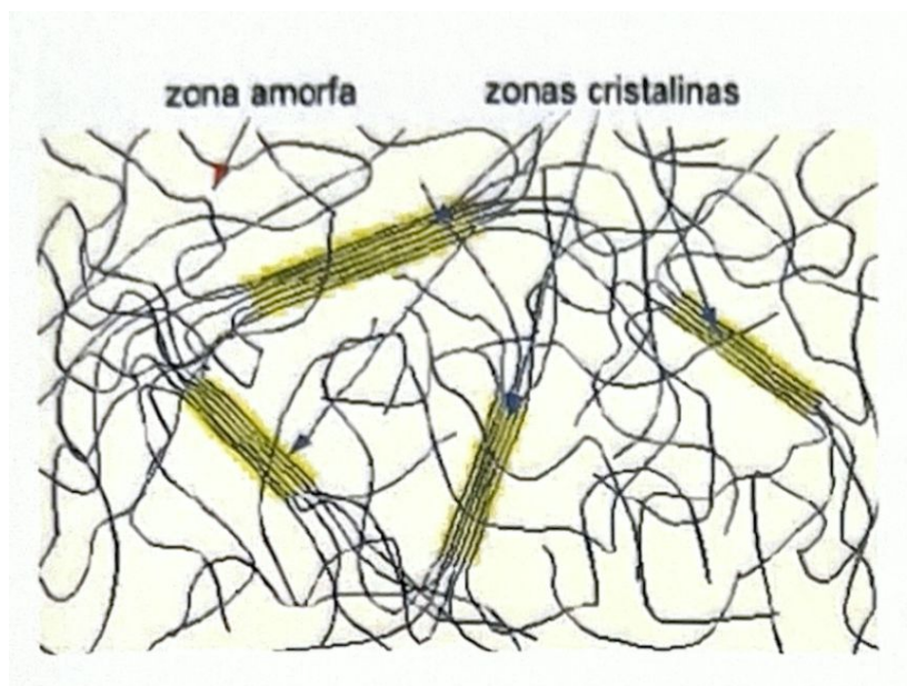
Ilustración 2.2 Estructura semicristalina donde se ven las diferentes zonas amorfas y cristalinas[13]
