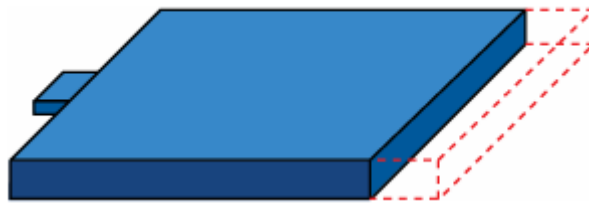
Ilustración 2.16 La variación dimensional es un cambio inesperado en las dimensiones de la pieza. [26]
