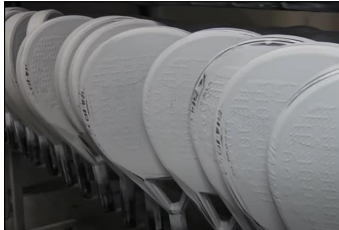
Ilustración 49. Proceso de secado en la cámara de calor previo a pintura.
