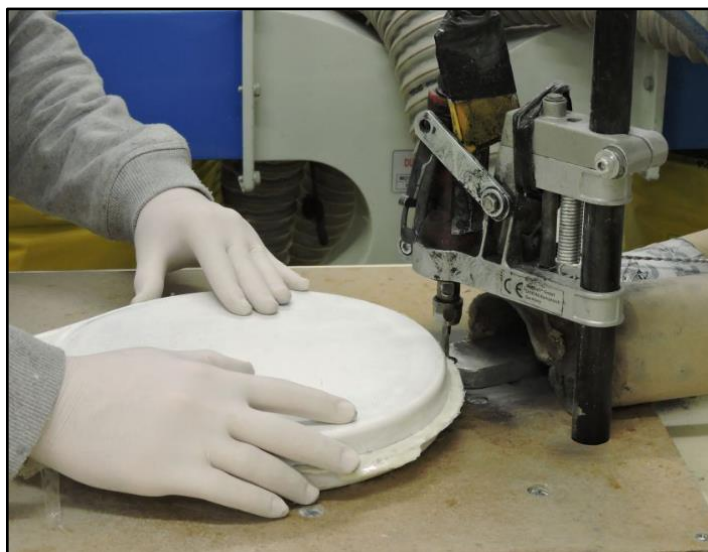
Ilustración 48. Operación de rebarbado para eliminar el material sobrante.
