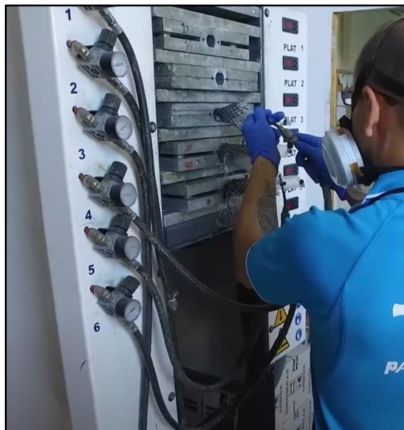
Ilustración 47. Presurizado de los tubos de aire dentro de la malla tubular.
