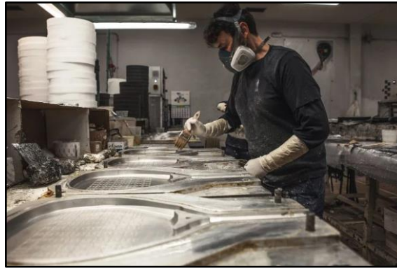
Ilustración 44. Aplicación de agente desmoldeante sobre la superficie del molde.
