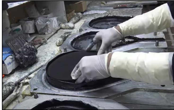
Ilustración 46. Colocación del núcleo troquelado en el molde.
