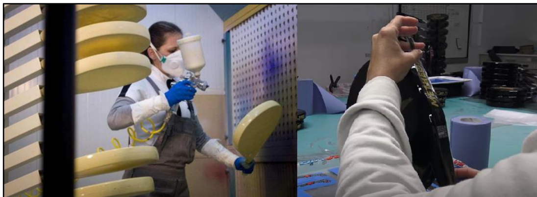
Ilustración 50. Operación de aplicación de pintura y colocación de calcas.
