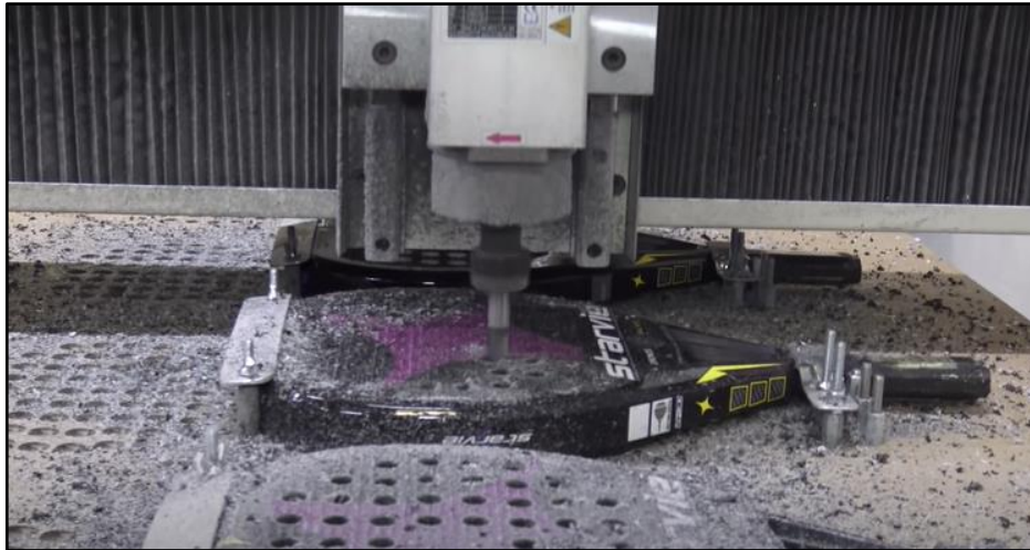
Ilustración 51. Operación de taladrado del patrón de agujereado.
