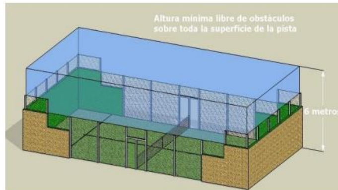
Ilustración 3. Altura mínima libre de obstáculos reglamentaria en una pista de Pádel.
