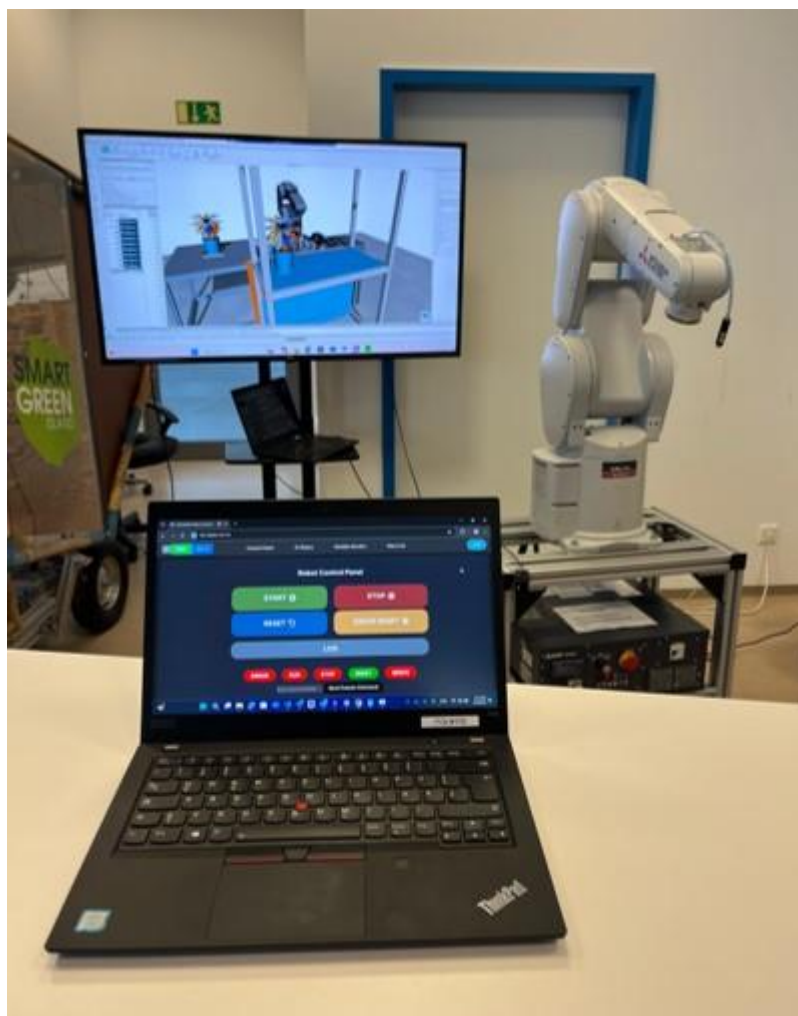
Ilustración 67: Robot Mitsubishi con el HMI ejecutado en un ordenador portátil y el Gemelo Digital reproducido en una pantalla.
