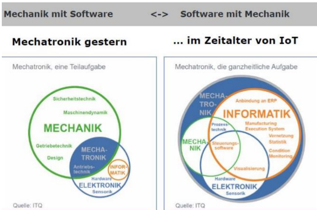
Ilustración 1: Comparación realizada hace 20 años entre la mecatrónica entonces y la predicción del futuro de la mecatrónica según ITQ
