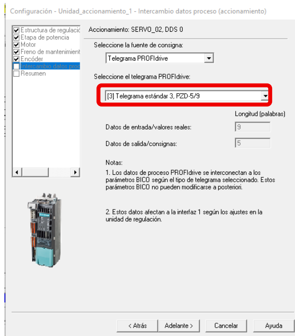
Figura 51. Configuración del variador. Intercambio de datos del proceso.
