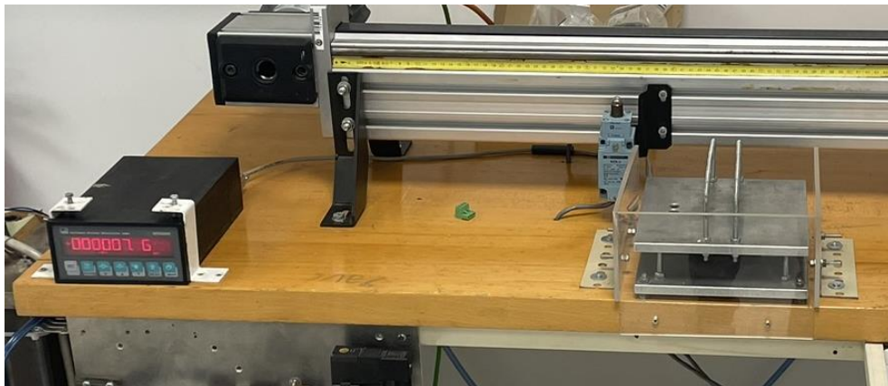
Figura 5. A la izquierda, acondicionador de señal. A la derecha, célula de carga.
