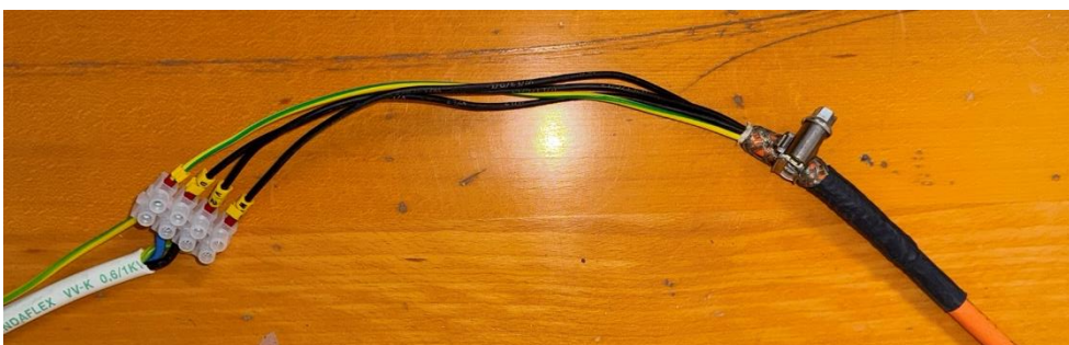
Figura 11. Conexión eléctrica de potencia del servomotor sobre la mesa.
