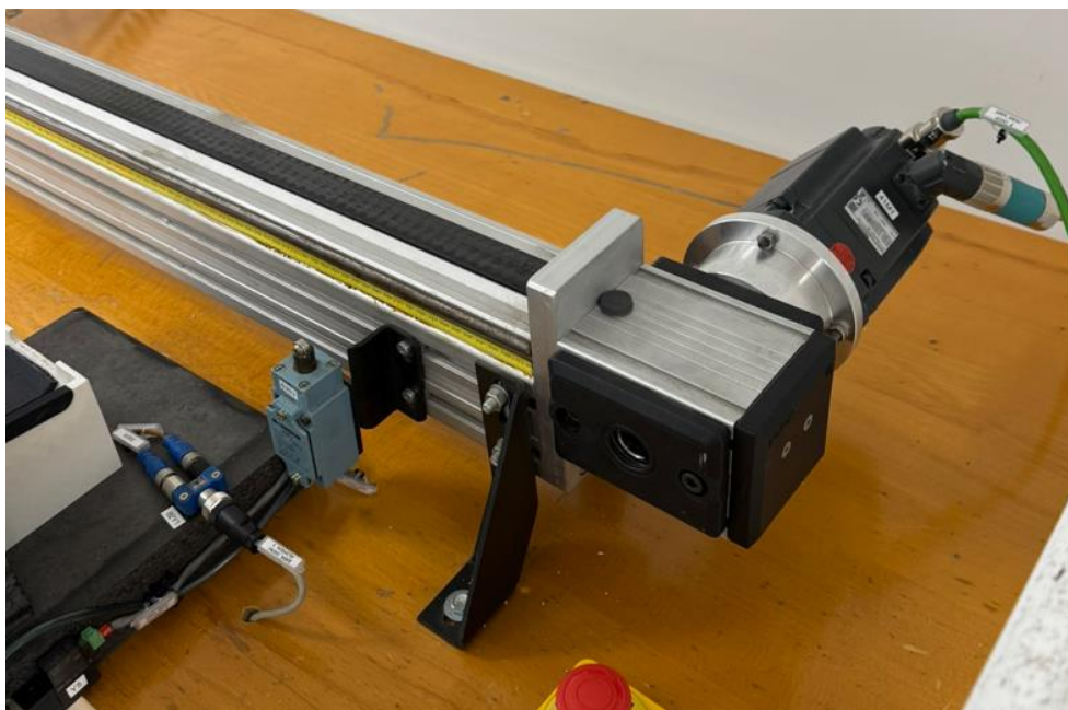
Figura 33. Nueva ubicación del motor en el extremo derecho de la guía.
