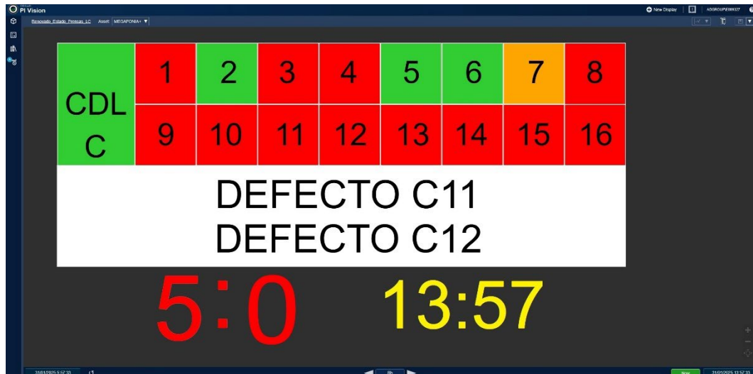
Figura 92. Nuevo sistema de visualización Línea C con PI Vision
