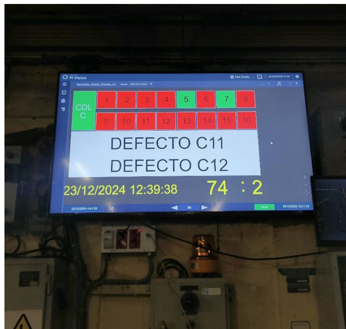
Figura 103. Pantalla Línea C de cocción con sistema nuevo (PI Vision)
