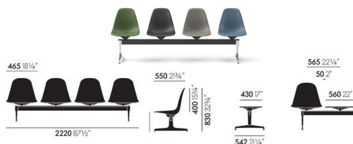
Fig. 190. Medidas del Eames Plastic Side Chair RE sobre travesaño
