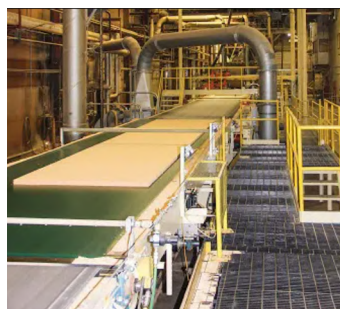
Fig.111. Fabricación de aglomerado.
