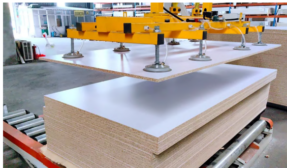
Fig.112. Fabricación de tableros de melamina.
