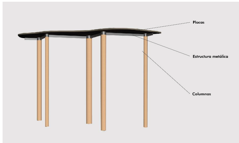
FIGURA 38. Partes de la cubierta. Elaboración propia
