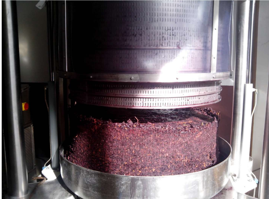
Figura 13: proceso de prensado de la uva tinta [29]
