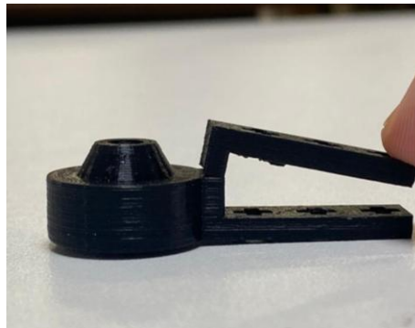
Figura 47. Rotura del anclaje
