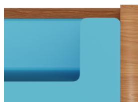
Figura 88. Sección de la pieza cubica, con hueco para introducir la pieza del sello.
