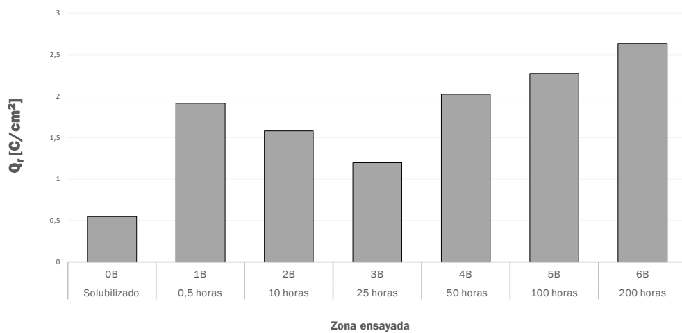
Figura 46 - Valores de Q_r de la zona afectada térmicamente. Ensayo EPR
