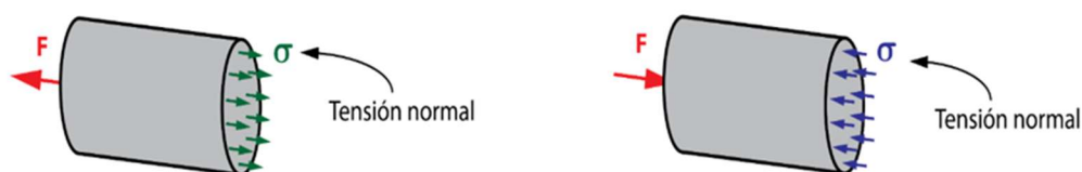
Figura 9, Representación tensión normal a tracción y compresión [4]
