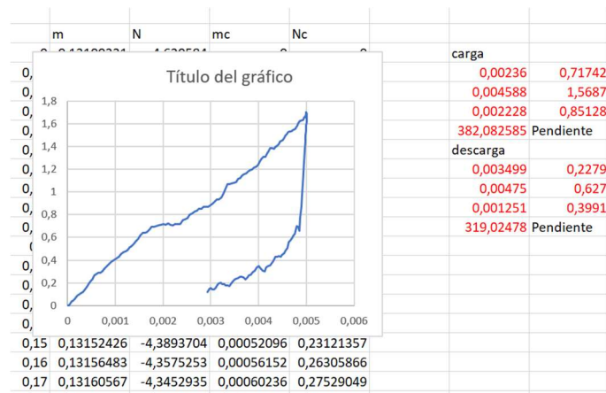
Figura 43, gráfica de dispersión desplazamiento-carga, palito 2
