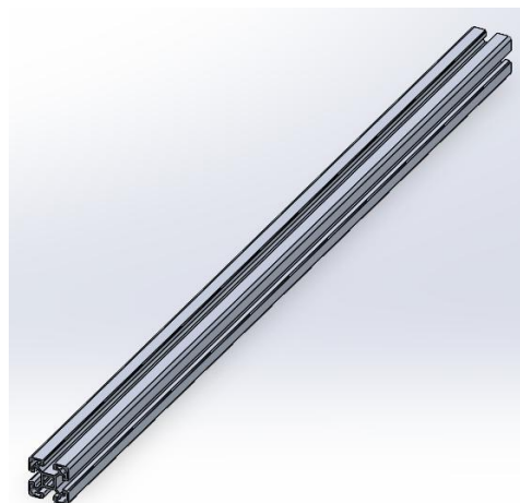
Figura 59 Modelo 3D de un perfil estructural de aluminio. Fuente: Propia
