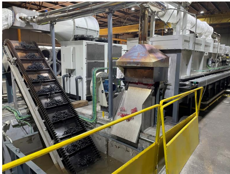
Figura 25 Horno de temple y revenido de los clips de reciente incorporación. Fuente: Propia
