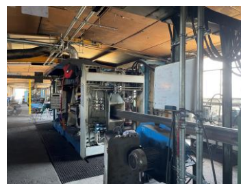
Figura 8 Máquina de soldadura de carril de 60kg/m. Fuente: Propia
