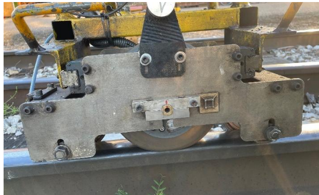
Figura 47 Contacto entre la rueda y la vía junto a su estructura. Fuente: Propia
