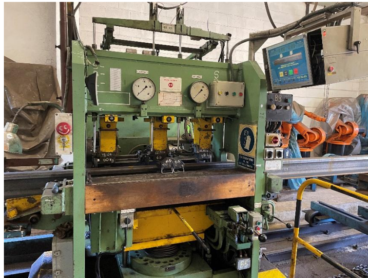
Figura 14 Prensa de ajuste del combeo de la soldadura. Fuente: Propia
