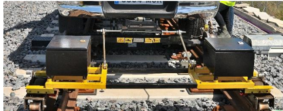
Figura 45 Vista trasera del sistema de remolcado del carro. Fuente: Adrián del Río
