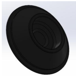
Figura 74 Modelo 3D del tope de goma de 30mm propio de patas. Fuente: Propia
