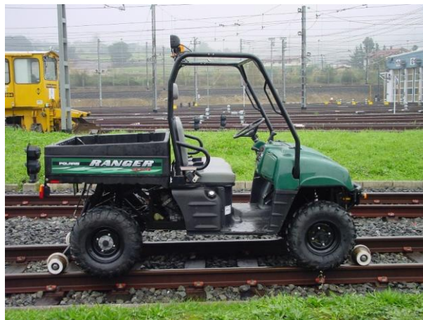
Figura 39 Primer vehículo convencional auscultador con ultrasonidos. Fuente: Adrián del Río
