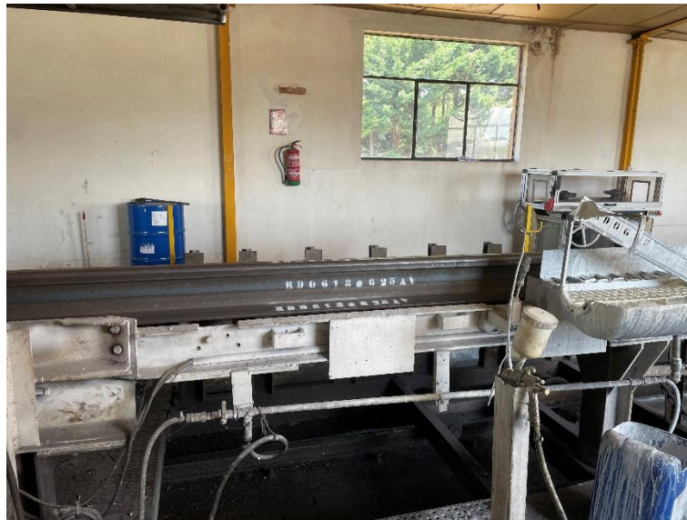
Figura 12 Carril marcado tras una soldadura exitosa. Fuente: Propia
