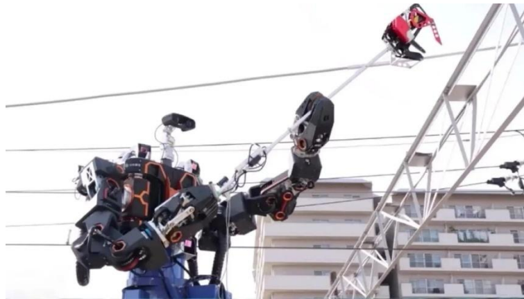
Figura 35 Robot de reparación de catenarias japonés. Fuente: 20 Minutos (2022)
