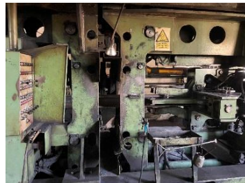
Figura 9 Máquina de soldadura de carril de 54kg/m. Fuente: Propia
