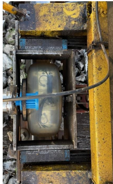
Figura 38 Imagen desde arriba de la rueda de ultrasonidos sobre la vía. Fuente: Propia
