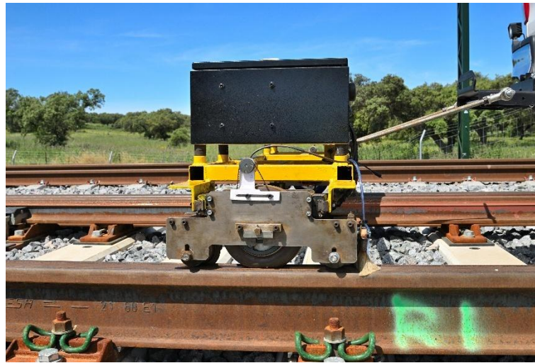
Figura 50 Vista lateral del carro de ultrasonidos con las cajas de componentes encima.
