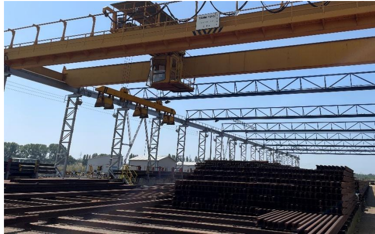
Figura 6 Almacén de los carriles procedentes de Arcelor y la grúa puente magnética. Fuente: Propia
