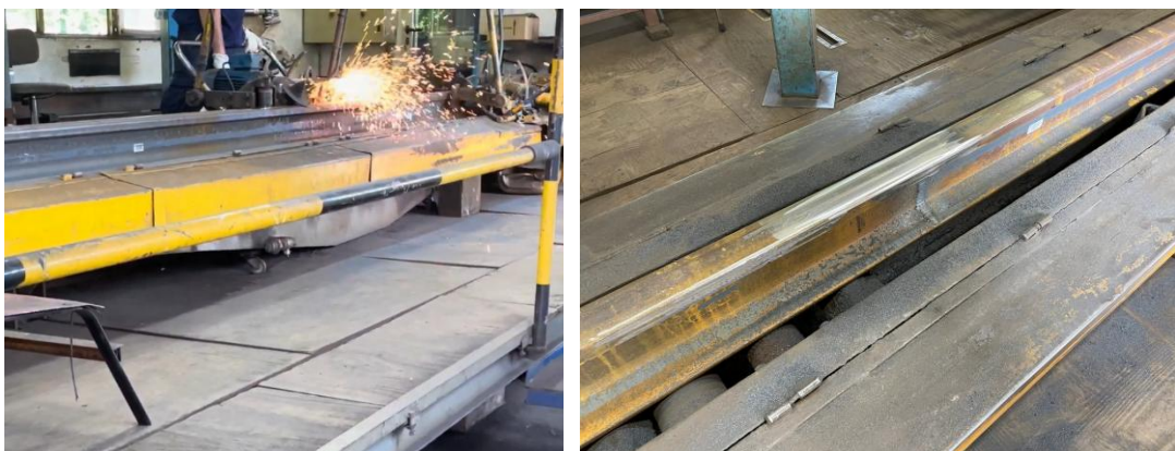
Figura 15 Carril durante el esmerilado y resultado final. Fuente: Propia
