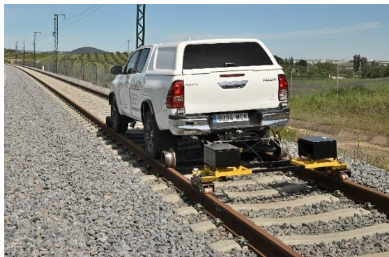
Figura 44 Vehículo Hilux auscultando con el carro de ultrasonidos. Fuente: Adrián del Río
