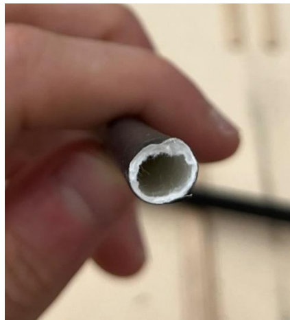
Figura 124. Superficie interior desgarrada tras alcanzar la fuerza máxima.
