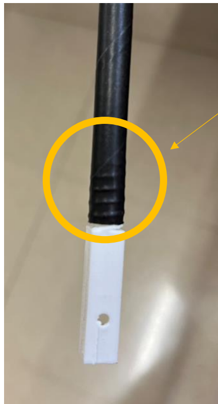
Figura 121. Nervios marcados en la superficie de la pajita al introducir la rosca de la unión.
