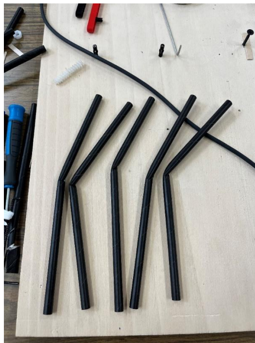
Figura 120. Deformación experimentada en los diferentes ensayos.
