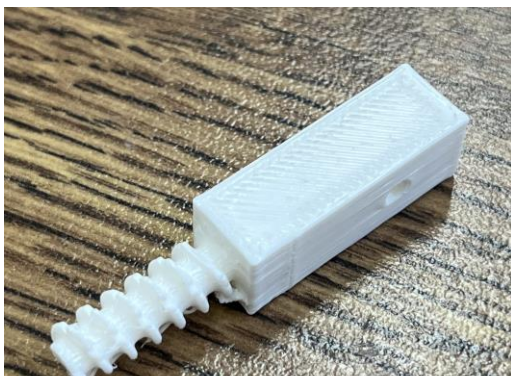
Figura 18. Prototipo 3D real de la unión para tracción
