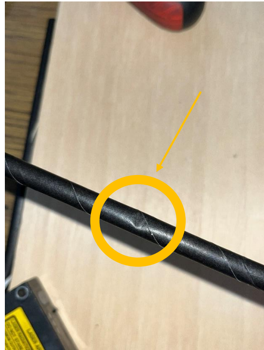
Figura 57. Deformación irreversible tras el ensayo de flexión.
