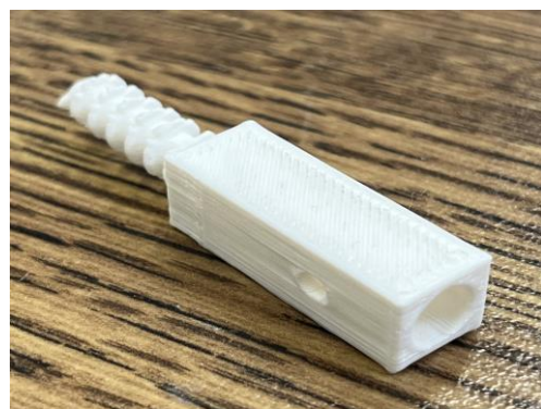
Figura 19. Prototipo 3D real de la unión para tracción
