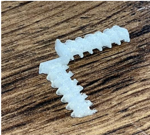
Figura 14. Prototipo 3D real de la unión de 90°
