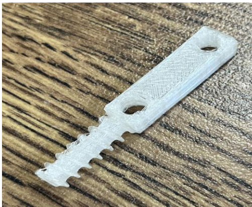
Figura 16. Prototipo 3D real de la unión pajita-tabla
